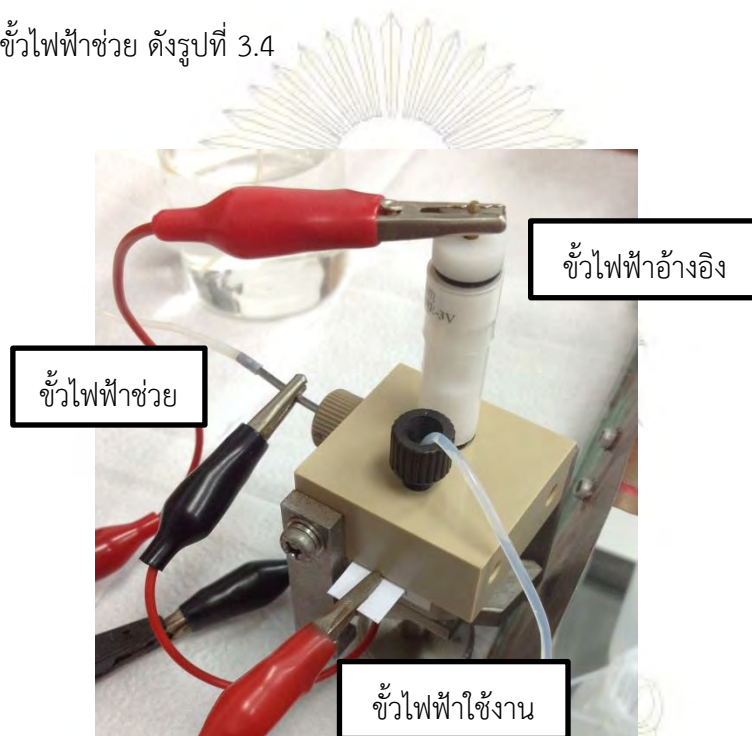
รูปที่ 3.4 การเชื่อมต่อขั้วไฟฟ้าทั้งสามชนิดกับเครื่อง potentiostat
