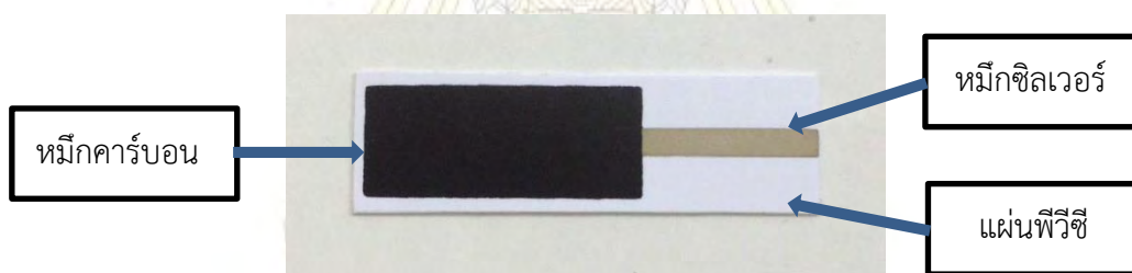
รูปที่ 3.1 (ข) ขั้วไฟฟ้าคาร์บอนพิมพ์สกรีน (screen-printed carbon electrode, SPCE)
