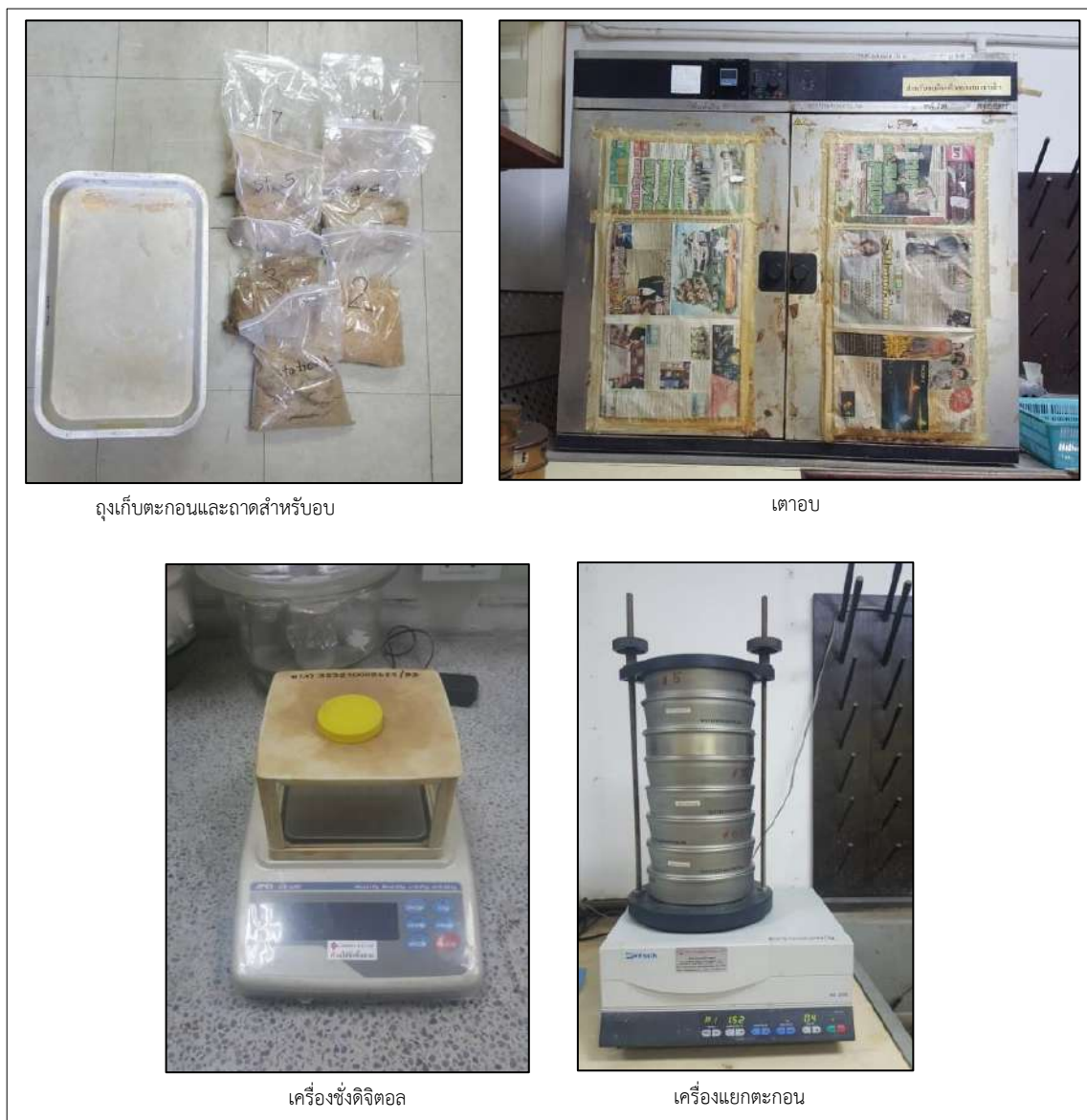
รูป 3.14 อุปกรณ์ที่ใช้ในห้องปฏิบัติการตะกอนวิทยา
