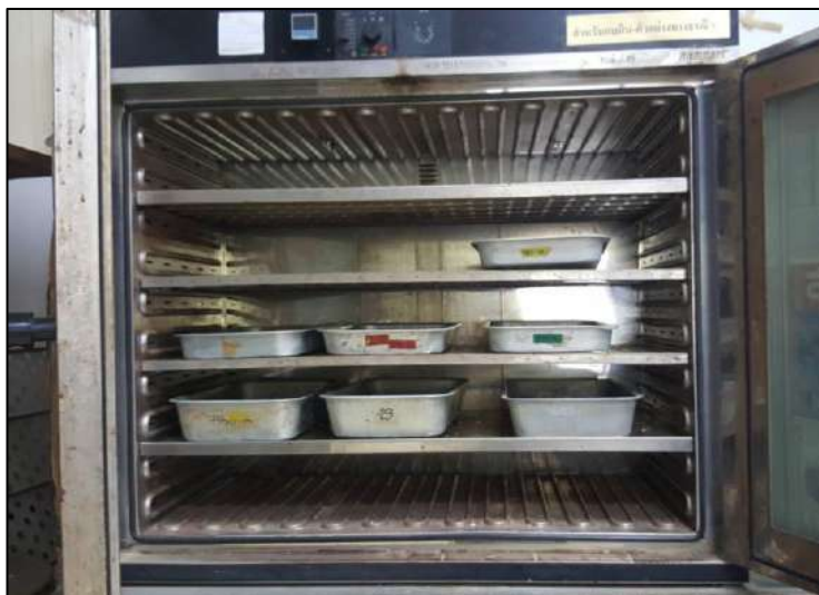
รูป 3.15 การนำตะกอนเข้าอบในเตาอบ เพื่อไล่ความชื้น
