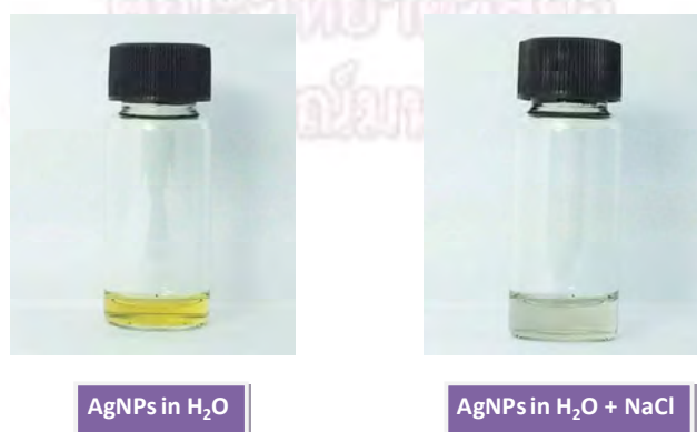
รูปที่ 4.12 แสดงผลการทดสอบอนุภาคเงินระดับนาโนรูปแบบทรงกลมกับโซเดียมคลอไรด์
