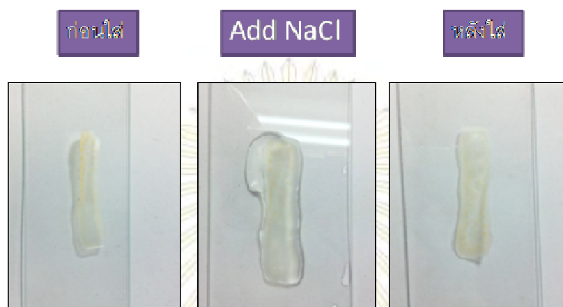
รูปที่ 4.13 แสดงผลการทดสอบการกระจายตัวของอนุภาคเงินระดับนาโน(ทรงกลม) ในพอลิสไตรีน
