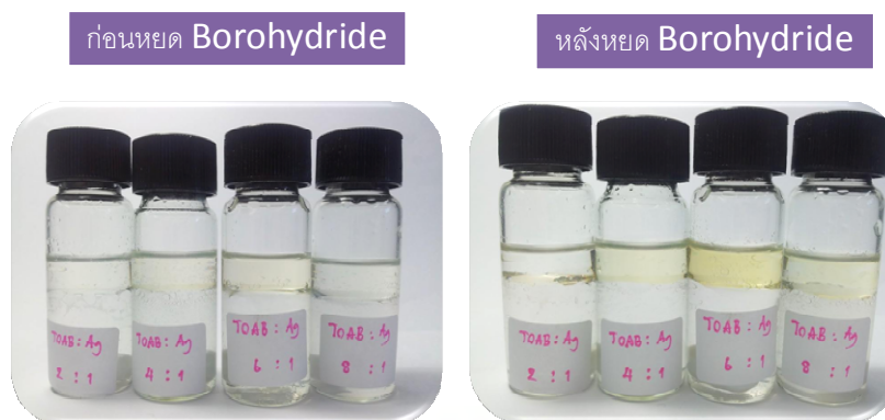
รูปที่ 4.14 แสดงผลการเคลื่อนย้ายอนุภาคเงินระดับนาโน (รูปแบบแผ่น) และการกระจายตัวของอนุภาคในชั้นโทลูอิน (ซ้าย) และเมื่อใส่โบโรไฮไดรด์เพิ่มลงไป (ขวา)
