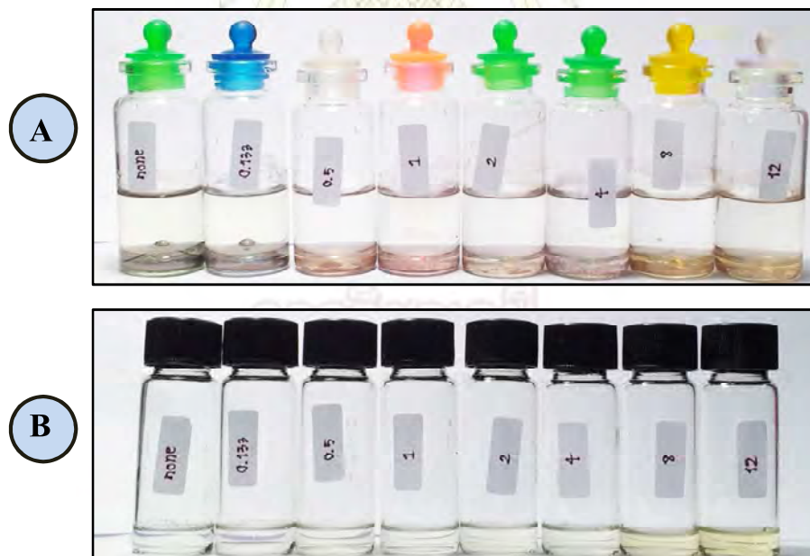
รูปที่ 4.8 แสดงผลการเคลื่อนย้ายอนุภาคเงินระดับนาโนและการกระจายตัวของอนุภาคในชั้นคลอโรฟอร์ม
