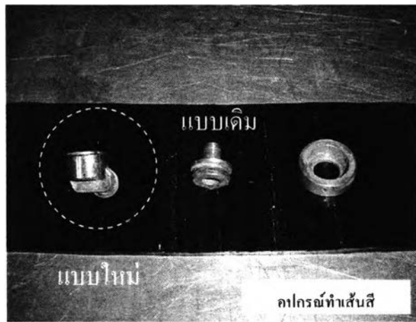
รูปที่ 4.18 การปรับปรุงอุปกรณ์สำหรับการปล่อยสี โดยเปลี่ยนเป็นแบบลูกกลิ้ง
