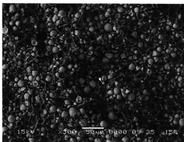
รูปที่ 4.27 สัณฐานวิทยาของชั้นทดสอบที่มีอัตราส่วน LDPE/EBS เป็น 90/10 และผสมแป้ง 100 phr
