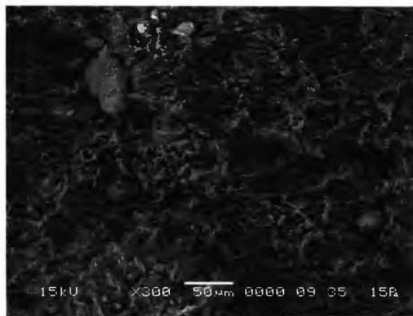
รูปที่ 4.23 สัณฐานวิทยาของชั้นทดสอบที่มีอัตราส่วน LDPE/EBS เป็น 70/30
