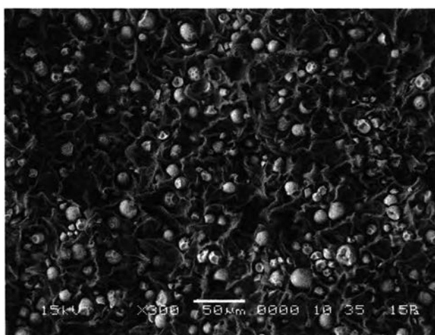
รูปที่ 4.25 สัณฐานวิทยาของชั้นทดสอบที่มีอัตราส่วน LDPE/EBS เป็น 90/10 และผสมแป้ง 33 phr
