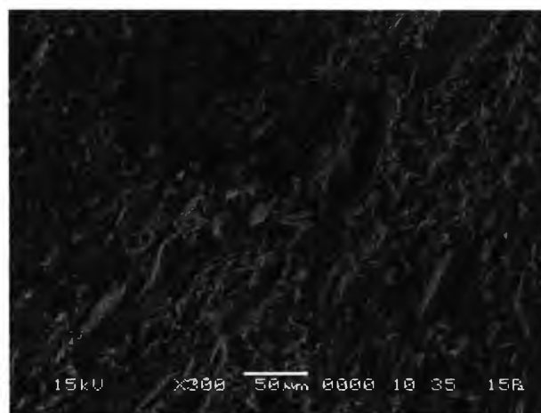
รูปที่ 4.24 สัณฐานวิทยาของชั้นทดสอบที่มีอัตราส่วน LDPE/EBS เป็น 50/50
