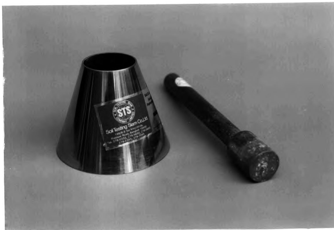
รูปที่ ผ.14 แสดงภาพกรวยหัวตัดสำหรับใช้ทดสอบความสามารถในการดูดซึมน้ำ
