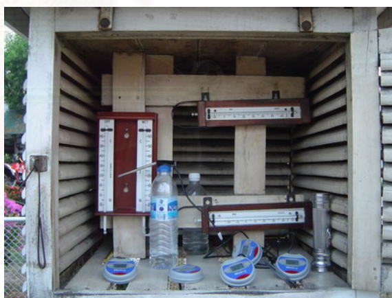
ภาพที่ 3.16 การติดตั้ง Microlog ในตู้สกรีน
