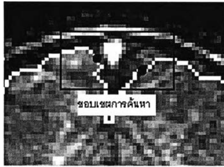
รูปที่ 27 ขอบเขตการค้นหาที่เล็กลงไปเนื่องจากการกำหนดจุดเริ่มต้นและจุดสิ้นสุดจาก ระยะห่างตามจำนวนจุดของเส้นแสดงรูปร่าง
