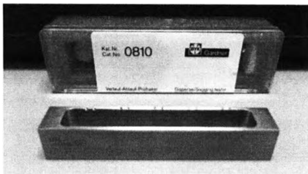
รูปที่ 3. 17 เครื่องทดสอบการไหลได้ระนาบและการขยับ (disperse/sagging tester) รุ่น 0810, Gardner GmbH
