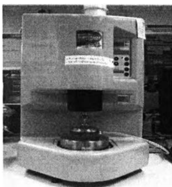
รูปที่ 3. 10 เครื่องรีโอมิเตอร์ (Ultra low torque Rotational rheometer, controlled stress) รุ่น Gemini 200HR nano, Malvern-Bhohlin Instrument
