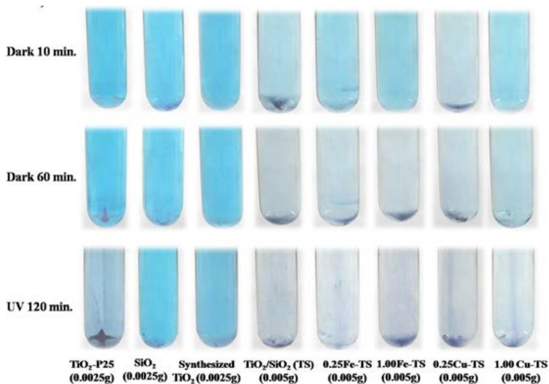
ภาพที่ 4.23 การเปลี่ยนสีของสารละลาย MB โดยใช้ตัวเร่งปฏิกิริยาชนิดต่างๆ ภายใต้การฉายแสงยูวีเอ
