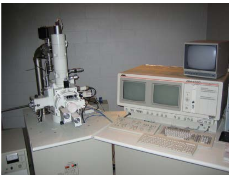
ภาพ ก-4 กล้องจุลทรรศน์อิเล็กตรอนแบบส่องกราด (SEM, JEOL รุ่น JSM 6400)
