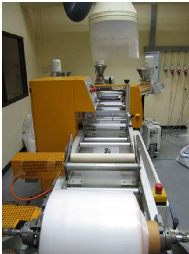
ภาพ ก-3 เครื่องหล่อแผ่นสกรูเดี่ยว (single-screw cast sheet, Collin)
