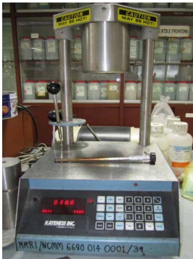
ภาพ ก-9 เครื่องวัดอัตราการหลอมไหลของพลาสติก (Galaxy I Melt Indexer, KAYENESS INC. รุ่น D 7053)
