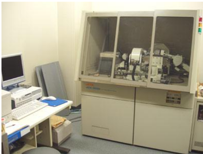
ภาพ ก-5 เอกซ์เรย์ดิฟแฟรกโตมิเตอร์ (XRD, JEOL รุ่น JDX 3530)
