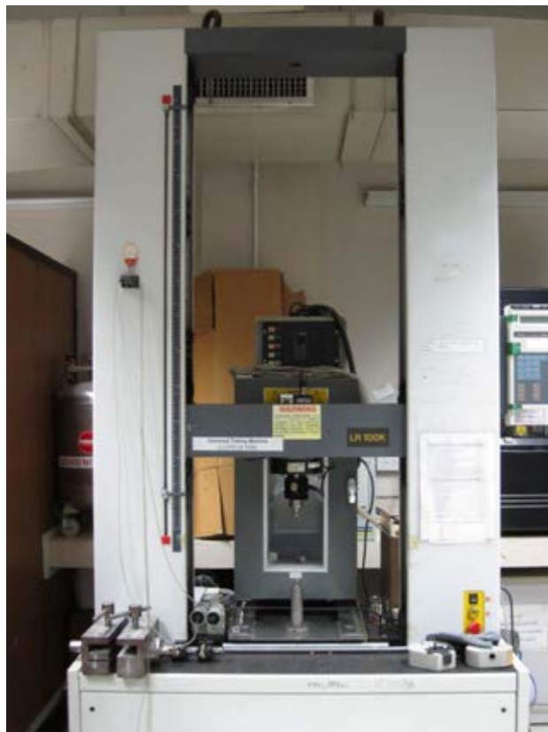
ภาพ ก-11 เครื่องทดสอบแรงดึง (LLOYD Universal Testing Machine รุ่น LR 100K)
