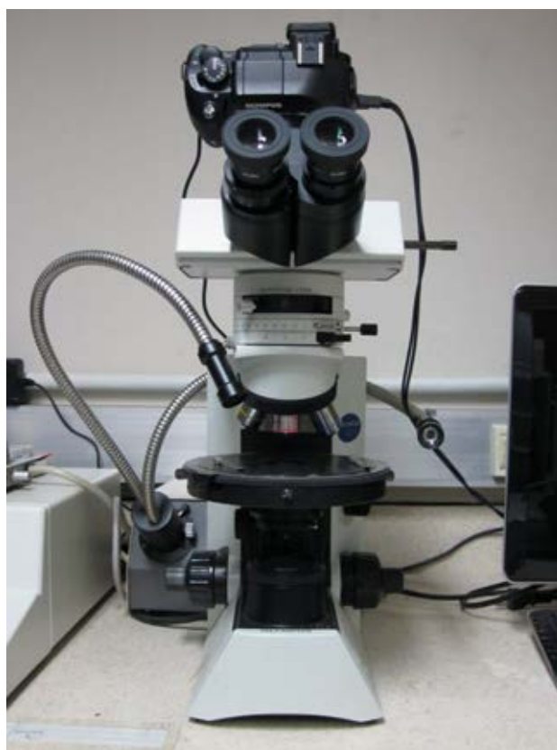
ภาพ ก-6 กล้องจุลทรรศน์แบบแสง (Optical Microscopy, Olympus รุ่น CX31)
