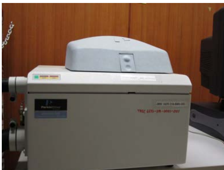
ภาพ ก-8 ดิฟเฟอเรนเชียลสแกนนิ่งคาลอริมิเตอร์ (DSC, Perkin-Elmer)
