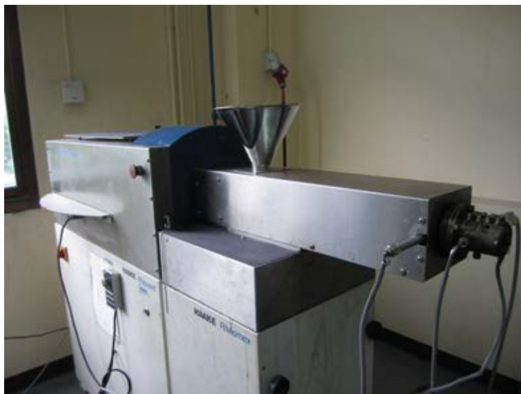
ภาพ ก-1 เครื่องอัดรีดสกรูเดี่ยว (single-screw extruder, Haake)
