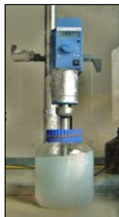
รูปที่ 3.1 อุปกรณ์การเตรียมเจลอิเล็กโทรไลต์ ก) ภาชนะสำหรับเตรียมเจลอิเล็กโทรไลต์ และ ข) เครื่องกวนที่สามารถปรับความเร็วรอบได้
