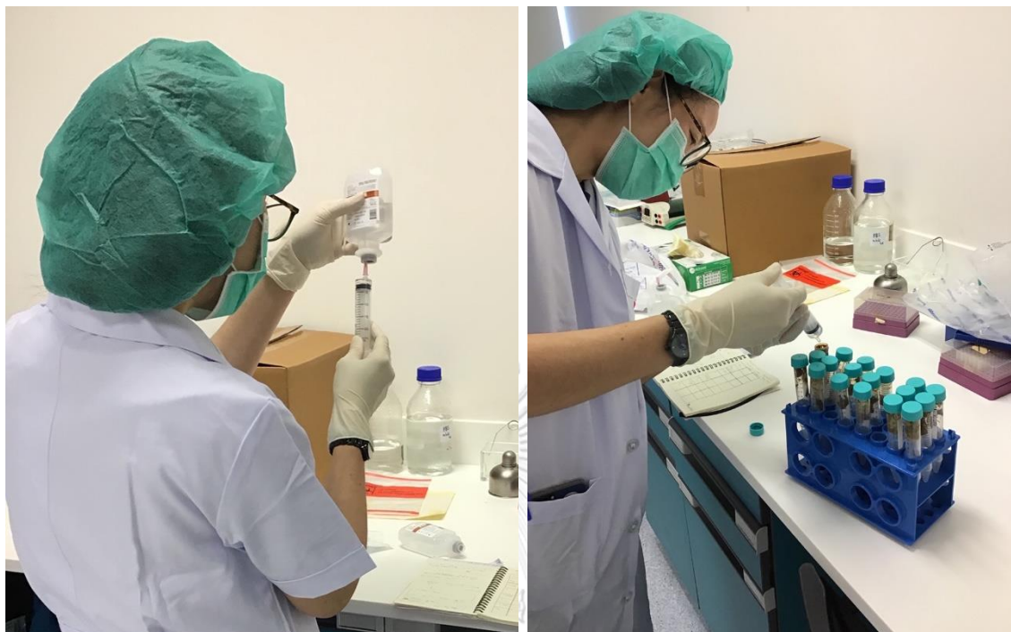
รูปที่ 5 แสดงการเจือจางตัวอย่างออกจากระเพื่อให้ได้สารละลายออกจากระความเข้มข้น 1:10
