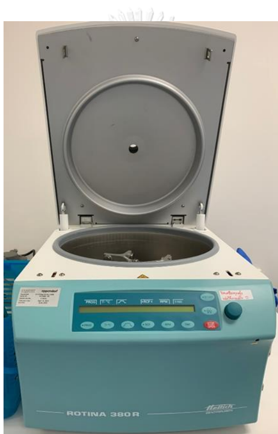
รูปที่ 6 แสดงเครื่องปั่นตกตะกอนที่ใช้ในการศึกษา
