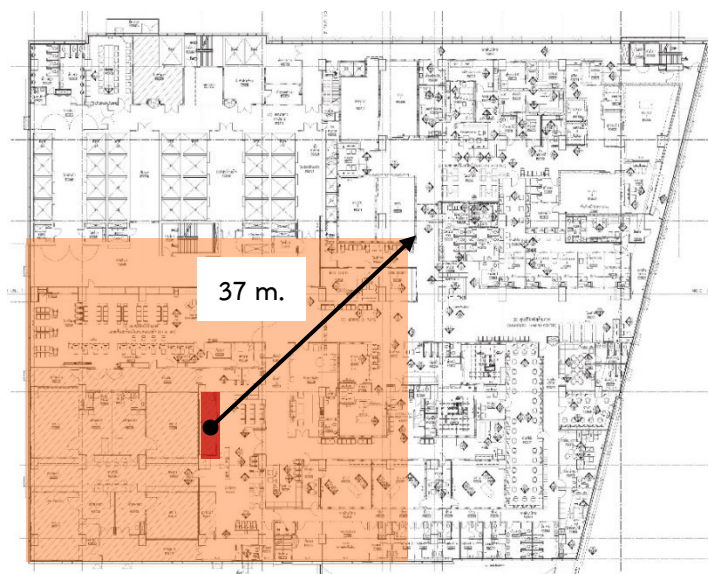
รูป 5.11 ขอบเขตของระดับความเสียหายระบุในผังฝ้าเพดานชั้น 2
