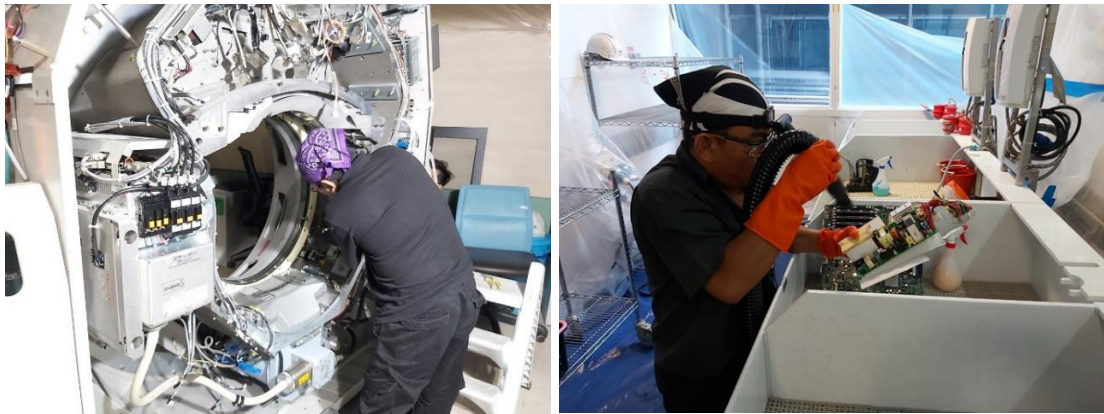
รูป 8.2 การกำจัดสิ่งปนเปื้อนด้วยน้ำ (ซ้าย) และ การกำจัดสิ่งปนเปื้อนแบบแห้งเพียงครั้งเดียว (ขวา)
