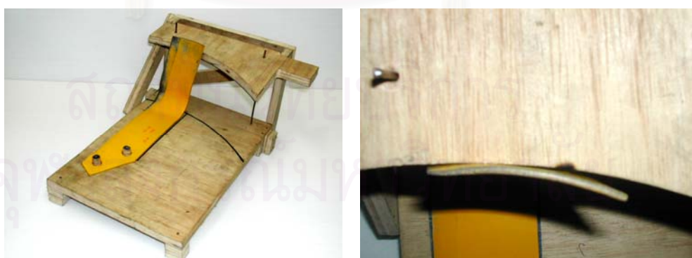
รูปที่ 3.10 เครื่องมือตรวจสอบขนาดของผิวตัก (Scoop surface)
