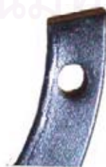
รูปที่ 2.6 ลักษณะด้ามใบมีดจอบหมุนแบบญี่ปุ่น
