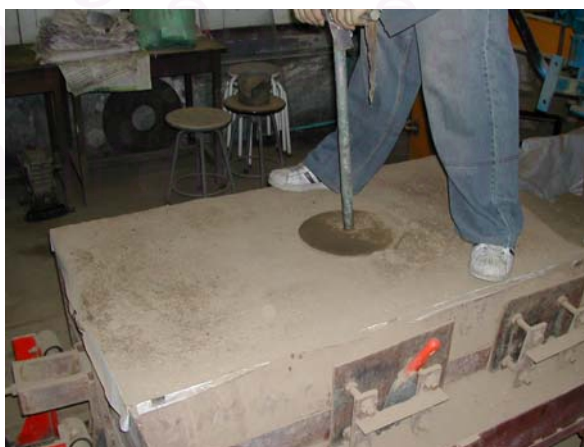
รูปที่ 5.5 การใช้เครื่องมืออัดดิน
