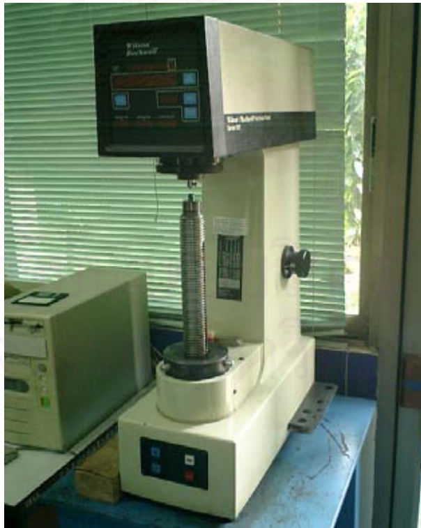
รูปที่ ข.3 เครื่องวัดความแข็ง Rockwell Hardness Tester; Wilson 500 model B 534-T
