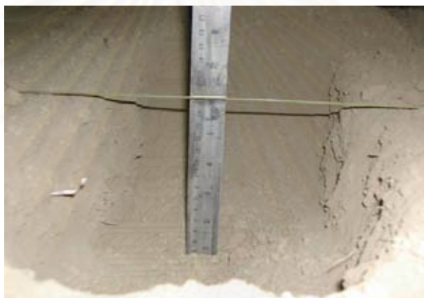
รูปที่ 7.9 การวัดความกว้างและความลึกการพรวนดิน
