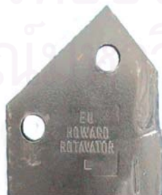
รูปที่ 2.3 ลักษณะด้ามใบมีดจอบหมุนแบบยุโรป
