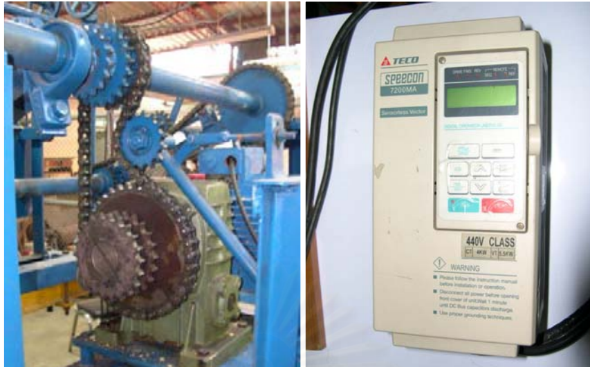
รูปที่ 4.7 ชุดเฟืองทดรอบและอินเวอร์เตอร์ที่ใช้ควบคุมความเร็วรอบเพลามาบิด
