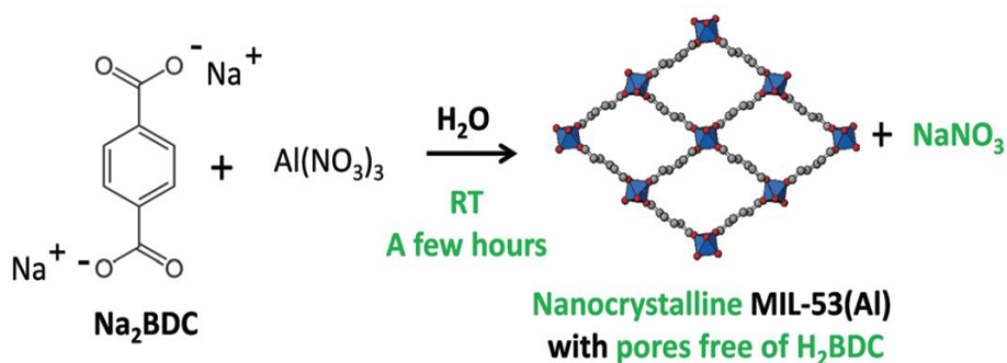
รูปที่ 2- 2 การสังเคราะห์ MIL-53 (Al) ที่อุณหภูมิห้อง (ที่มา: Sánchez และคณะ, 2015)
