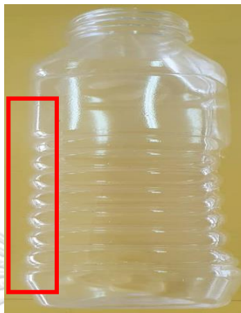
รูปที่ 2-61 แสดงของเสียประเภทเหลี่ยมไม่เต็ม
