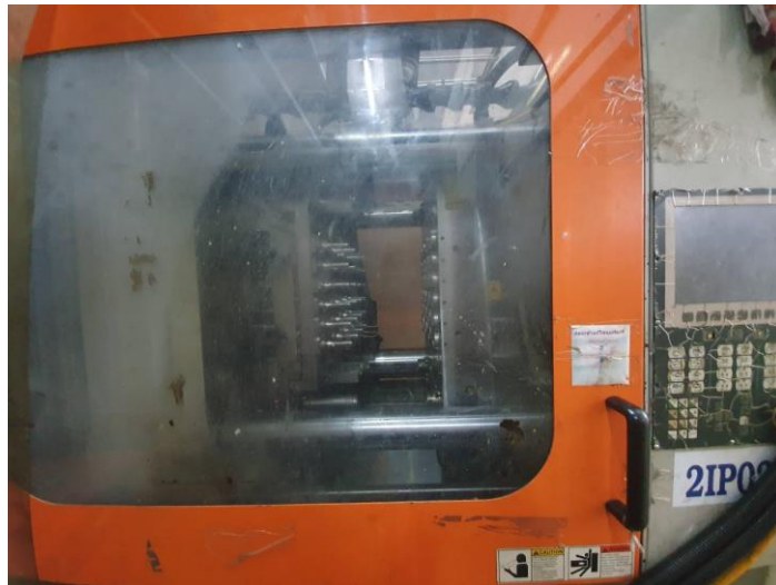
รูปที่ 2-15 แสดงการดันหลอดพรีฟอร์มออกจาก Core ถ่ายเมื่อ ; 30 พฤษภาคม 2563
