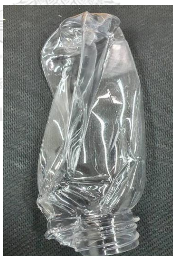
รูปที่ 2-54 แสดงของเสียประเภททับหน้าแม่พิมพ์
