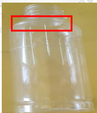
รูปที่ 2-50 แสดงของเสียประเภทเป็นไต
