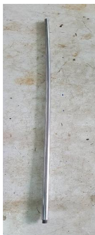
รูปที่ 4-11 แสดง stretch rod เกิดการงอ ถ่ายเมื่อ ; 22 พฤศจิกายน 2561
