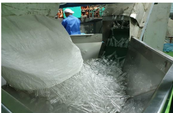
รูปที่ 2-20 แสดงการโหลดหลอดพรีฟอร์ม
