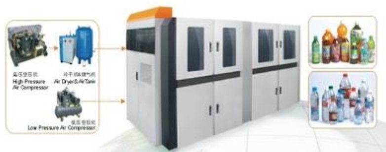
รูปที่ 2-3 วิธีการผลิตขวดเพทแบบ Two-Step “Cold perform” method (ที่มา : http://newengineeringpractice.blogspot.com/2011/08/manufacturing-of-plastic-bottles.html )
