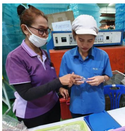
รูปที่ 4-7 แสดงการตรวจสอบคุณภาพหลอดพรีฟอร์มก่อนนำไปเป่าขวดเพท ถ่ายเมื่อ ; 3 มีนาคม 2562
