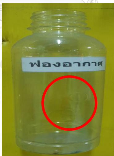
รูปที่ 2-72 แสดงของเสียประเภทฟองอากาศ
