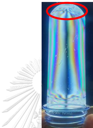
รูปที่ 2-43 แสดงของเสียประเภทก้นแน่น
