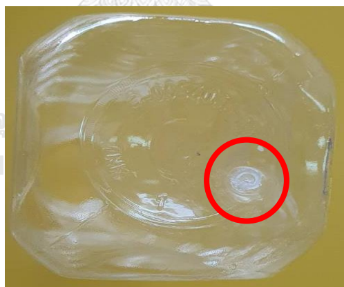
รูปที่ 2-56 แสดงของเสียประเภทก้นไม่ตรง
