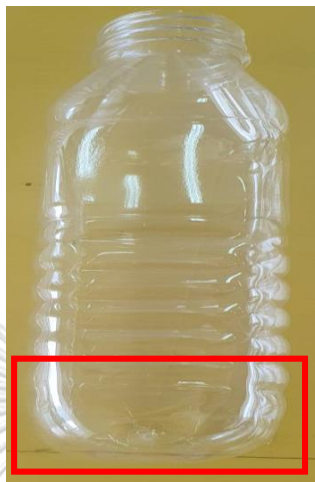
รูปที่ 2-57 แสดงของเสียประเภทเป่าไม่เต็มใบ
