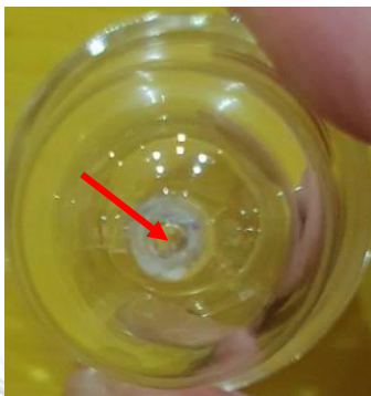
รูปที่ 2-39 แสดงของเสียประเภทก้นใส
