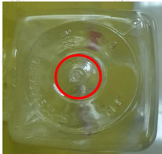
รูปที่ 2-70 แสดงของเสียประเภทก้นนูน ถ่ายเมื่อ ; 30 พฤษภาคม 2563
