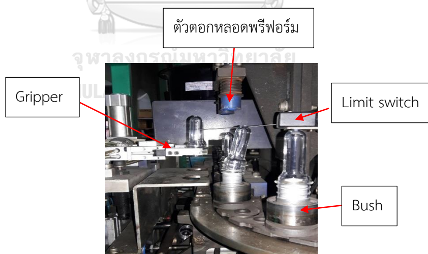
รูปที่ 4-8 แสดงหลอดพรีฟอร์มเอียงบน Bush และชน limit switch
