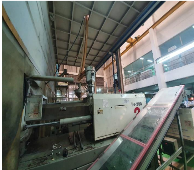
รูปที่ 2-7 แสดงการดูดเม็ดพลาสติกเข้า Hopper ถ่ายเมื่อ ; 30 พฤษภาคม 2563
