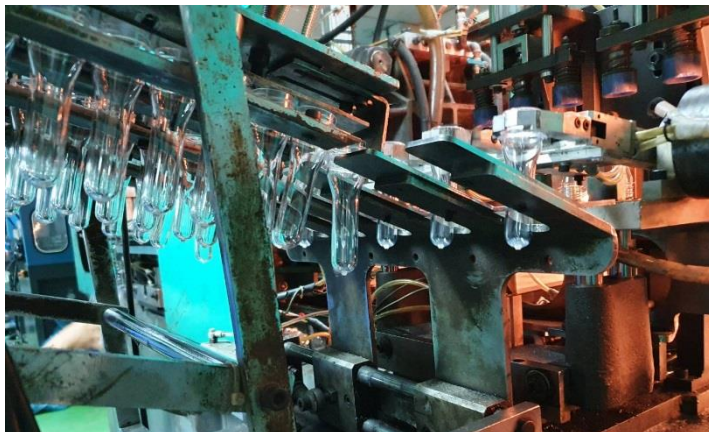
รูปที่ 2-22 แสดง Gripper หยิบหลอดพรีฟอร์ม ถ่ายเมื่อ ; 25 พฤษภาคม 2563
