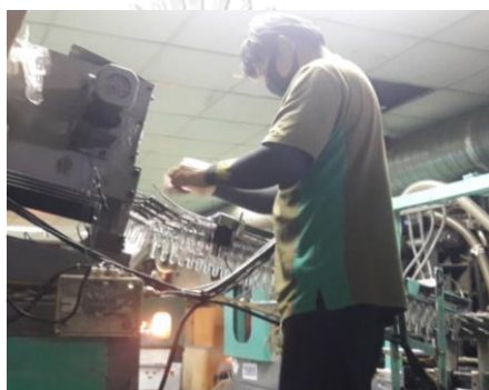
รูปที่ 4-10 แสดงการปรับตั้งรางสไลด์หลอดพรีฟอร์ม ถ่ายเมื่อ ; 21 พฤศจิกายน 2561
