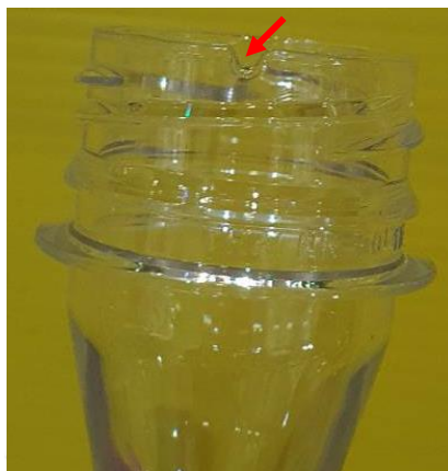
รูปที่ 2-41 แสดงของเสียประเภทปากไม่เต็ม
