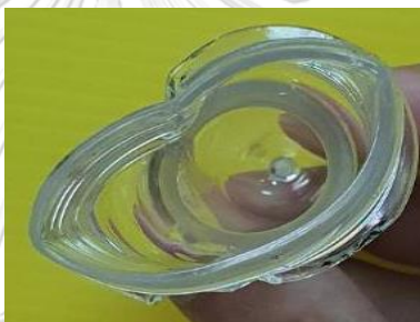
รูปที่ 2-47 แสดงของเสียประเภทหลอดติดสไลด์
