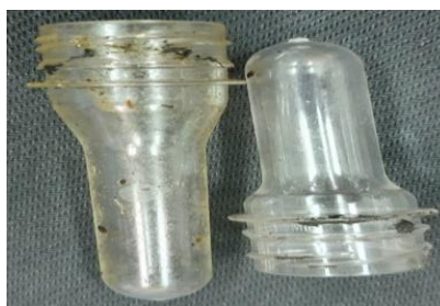
รูปที่ 2-48 แสดงของเสียประเภทหลอดเก็บตก
