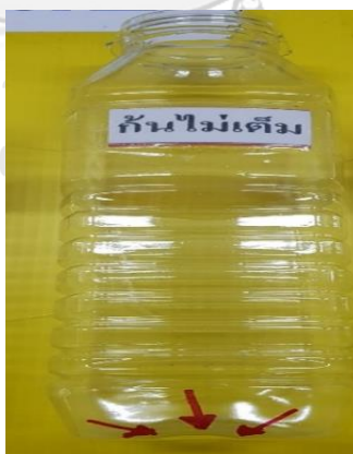
รูปที่ 2-62 แสดงของเสียประเภทก้นไม่เต็ม
