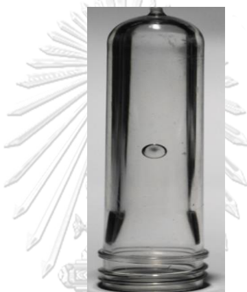
รูปที่ 2-73 แสดงฟองอากาศบนหลอดพรีฟอร์ม
