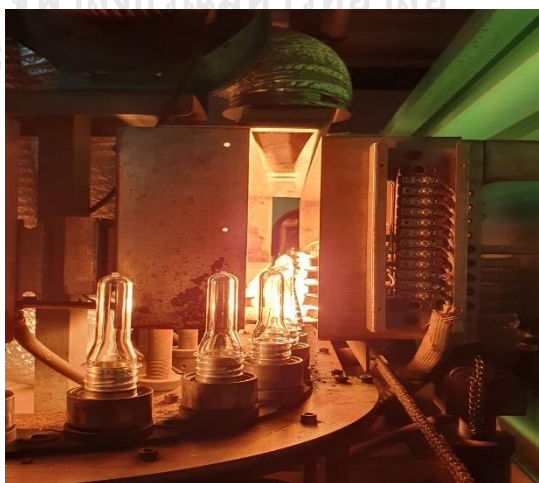
รูปที่ 2-24 แสดงการให้ความร้อนหลอดฟลูออโรสผ่านตู้อบอินฟราเรด
