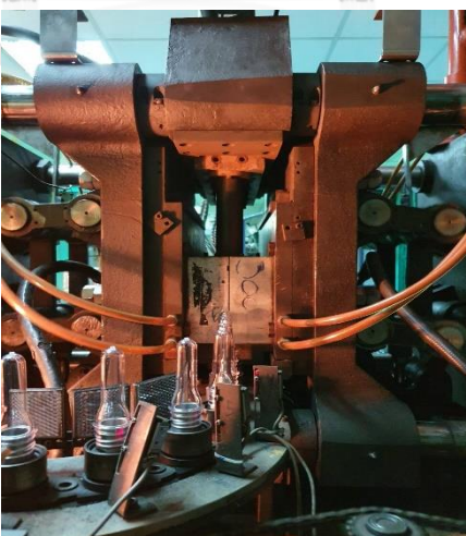
รูปที่ 2-26 แสดงแม่พิมพ์เป่าขวดเพทปิดประกบ ถ่ายเมื่อ ; 25 พฤษภาคม 2563
