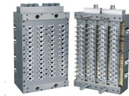
รูปที่ 2-9 แม่พิมพ์พรีฟอร์มฝั่ง Core และ Cavity
