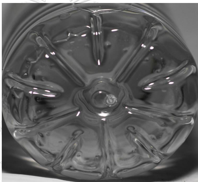
รูปที่ 2-79 แสดงกันขวดไม่ตรง
