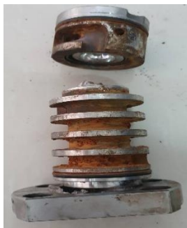
รูปที่ 4-6 แสดง Cavity แดก ถ่ายเมื่อ ; 18 มกราคม 2562
