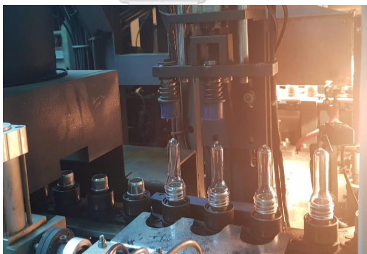
รูปที่ 2-23 แสดงหลอดพรีฟอร์มที่สวมเข้ากับ Bush ถ่ายเมื่อ ; 25 พฤษภาคม 2563
