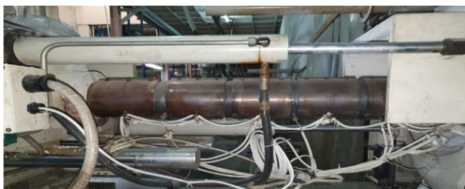
รูปที่ 4-5 แสดง Heater รอบสกรู
