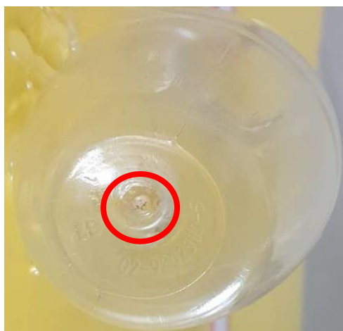
รูปที่ 2-71 แสดงของเสียประเภทก้นไหม้
