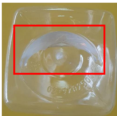
รูปที่ 2-53 แสดงของเสียประเภทก้นร้อน
