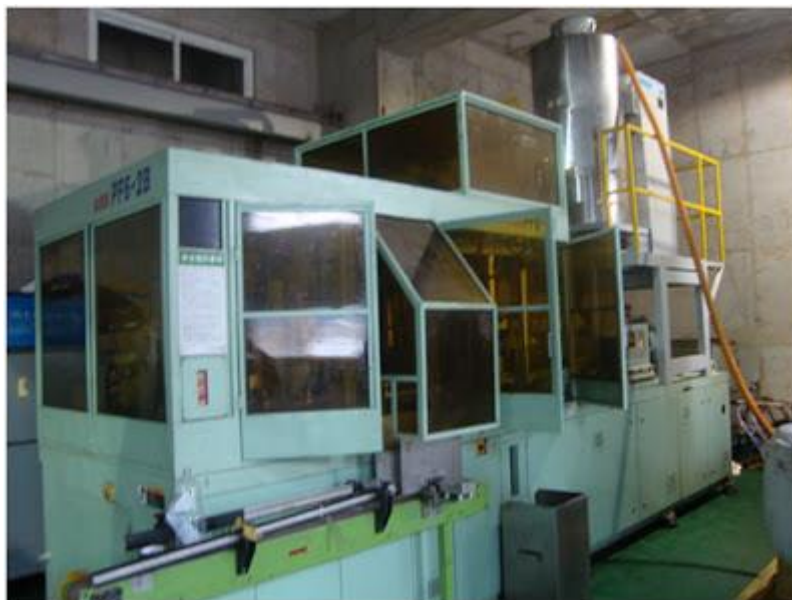
รูปที่ 2-2 วิธีการผลิตขวดเพทแบบ One-Step “hot perform” method (ที่มา : http://newengineeringpractice.blogspot.com/2011/08/manufacturing-of-plastic-bottles.html )
