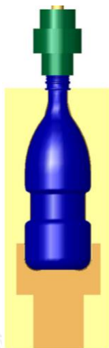
รูปที่ 2-32 แสดงแม่พิมพ์ที่ถูกเป่าขยายออกจนเต็มแม่พิมพ์
