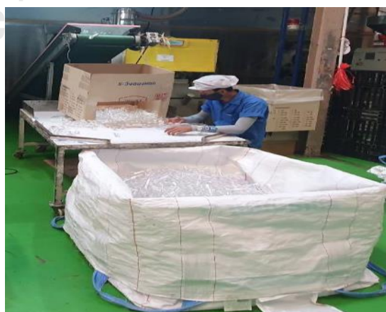
รูปที่ 2-18 แสดงการตัดคุณภาพหลอดพีพีฟอร์มและบรรจุลงหีบห่อ
