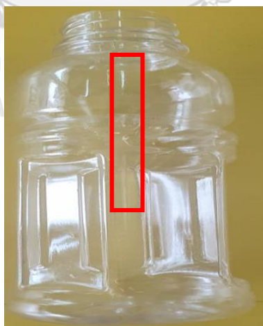
รูปที่ 2-68 แสดงของเสียประเภทตะเข็บเหลี่ยม
