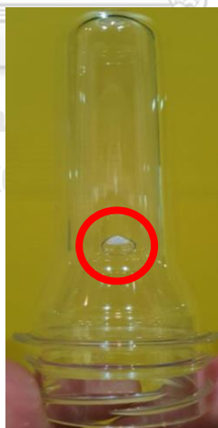
รูปที่ 2-38 แสดงของเสียประเภทฟองอากาศ ถ่ายเมื่อ ; 30 พฤษภาคม 2563
