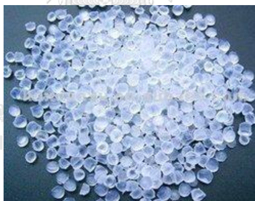
รูปที่ 2-4 เม็ดพลาสติกชนิดโพลีเอทิลีนเทเรฟธาเลต
