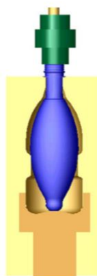
รูปที่ 2-31 แสดงแม่พิมพ์เป่าขวดเมื่อ Stretch rod ยืดออกสุด
