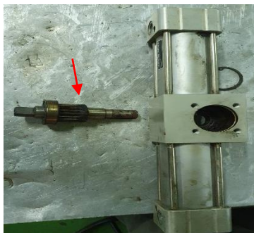
รูปที่ 4-9 แสดงเฟืองกระบอก Rotate เกิดความเสียหาย ถ่ายเมื่อ ; 21 พฤศจิกายน 2561
