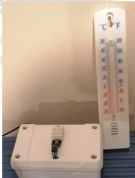
รูปที่ 4.7 อุปกรณ์สำหรับการวัดอุณหภูมิและความชื้น โดยส่งข้อมูลและแสดงผลบนแอปพลิเคชัน
