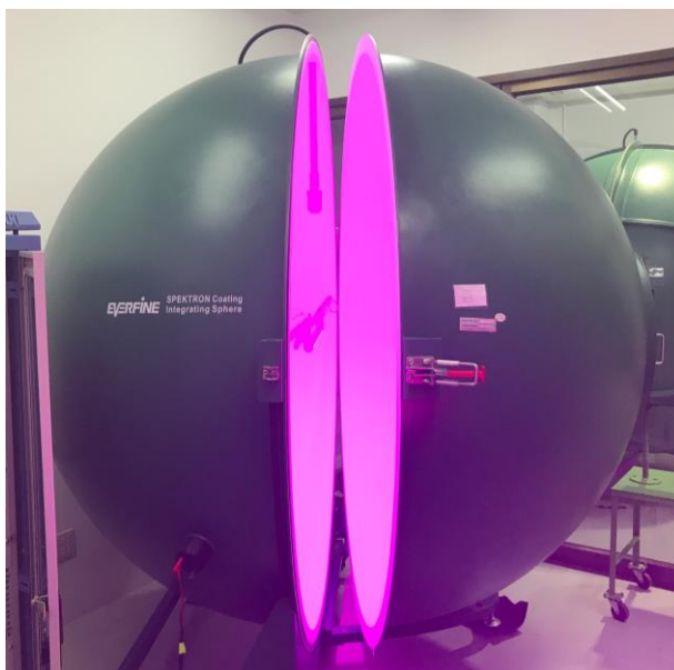
รูปที่ 3.6 เครื่องมือสำหรับวัดค่าคุณลักษณะทางแสงและสี หรือ เครื่อง Integrating Sphere
