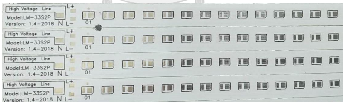
รูปที่ 3.3 แผ่นวงจร PCB รูปแบบการต่อวงจรเม็ดแอลอีดีแบบ 33S2P
