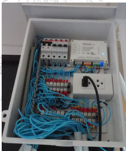
รูปที่ 4.5 ชุดควบคุมระบบแสงสว่างและระบบน้ำสำหรับแปลงปลูกผักชี
