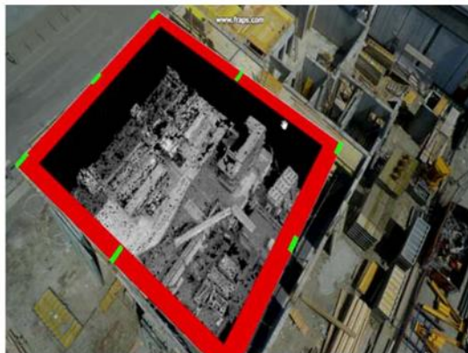
รูปที่ 2.21 การใช้เทคโนโลยี AR ด้วยเทคนิคเลนส์วิเศษสามมิติ (Zollmann et al., 2014)
