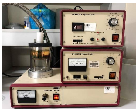
รูปที่ 3-9 การเตรียมตัวอย่างดินในการทดสอบโครงสร้างทางจุลภาค (SEM); (a) เครื่องฉาบทอง; (b) ตัวอย่างดินที่ถูกเคลือบทอง
