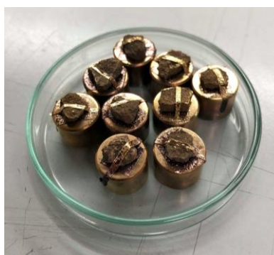
รูปที่ 3-9 การเตรียมตัวอย่างดินในการทดสอบโครงสร้างทางจุลภาค (SEM); (a) เครื่องฉาบทอง; (b) ตัวอย่างดินที่ถูกเคลือบทอง
