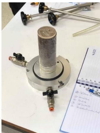
รูปที่ 3-8 การเตรียมตัวอย่างเพื่อทำการทดสอบหาค่าโมดูลัสคืนตัว; (a) การห่อหุ้มตัวอย่างดินด้วยเมมเบรน; (b) การติดตั้งอุปกรณ์ก่อนเริ่มทำการทดลอง
