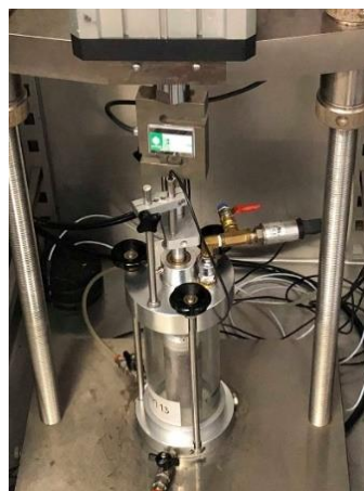
รูปที่ 3-8 การเตรียมตัวอย่างเพื่อทำการทดสอบหาค่าโมดูลัสคืนตัว; (a) การห่อหุ้มตัวอย่างดินด้วยเมมเบรน; (b) การติดตั้งอุปกรณ์ก่อนเริ่มทำการทดลอง
