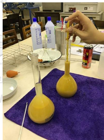
รูปที่ 3-2 การทดสอบหาความถ่วงจำเพาะของดิน; (a) การสอบเทียบขวดปรับปริมาตร; (b) การทดสอบหาความถ่วงจำเพาะของดิน
