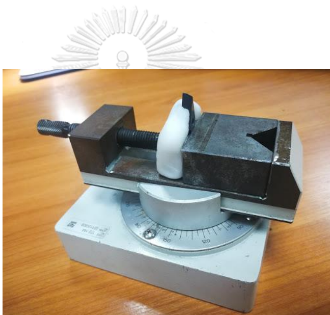
รูปที่ 3.15 การยึดจับเม็ดมิต ด้วยปากกาจับงานและบล็อกพลาสติก
