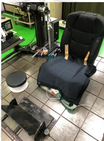
รูปที่ 3.11 ติดตั้งอุปกรณ์ Pressure Mapping System
