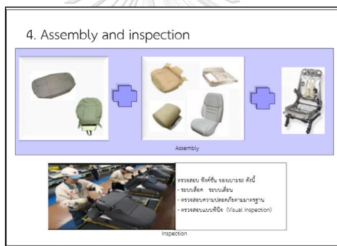
รูปที่ 1.7 การประกอบชิ้นงานเป็นเบาะ
