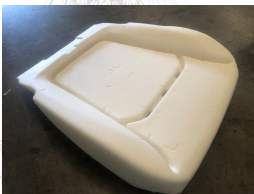
รูปที่ 3.9 โฟมของเบาะรองนั่งรถยนต์ทั้ง 3 หมายเลข
