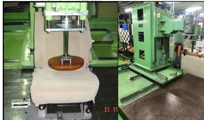
รูปที่ 2.30 เครื่อง Load test และ ระยะที่ใช้ในการทดลองชิ้นงาน ตำแหน่งในการทดลองชิ้นงานทั้งที่เบาะรองนั่งและพนักพิงของเบาะรถยนต์
