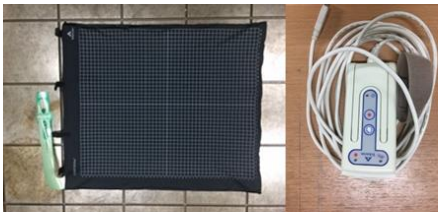
รูปที่ 3.2 เครื่อง Pressure Mapping System และโปรแกรมซอฟต์แวร์
