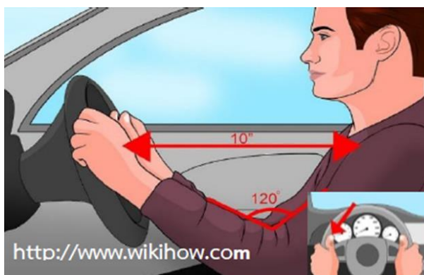
รูปที่ 2.5 การปรับระดับของพวงมาลัย ที่มา : ( http://www.wikihow.com )
