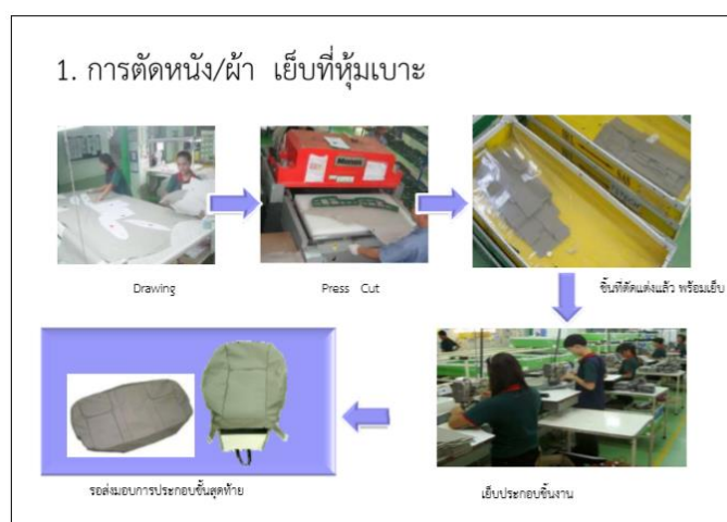
รูปที่ 1.4 การตัดหนัง / ผ้า เย็บที่หุ้มเบาะ
