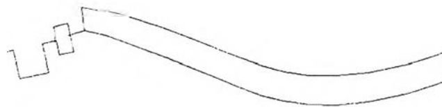
รูปที่ 2.5 สัญญาณวิทยุทัศน์เมื่อผ่านการสแครมเบิลด้วยวิธีคลื่นรบกวน
