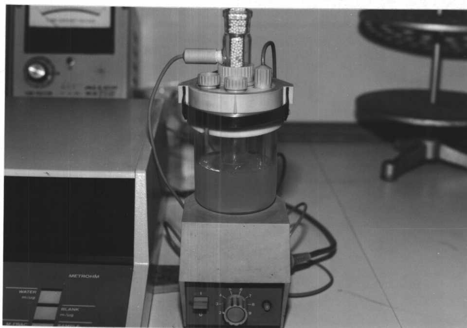
รูปที่ 3.6 อุปกรณ์ทดสอบหาปริมาณน้ำขณะทำงาน
