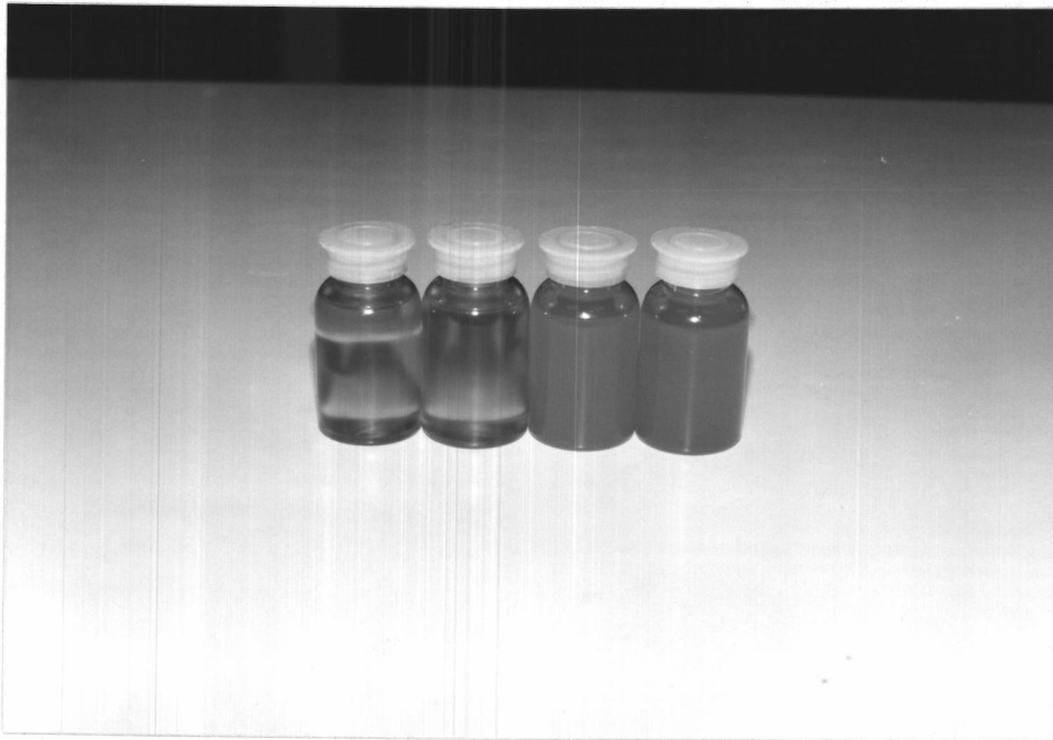
รูปที่ 3.14 ตัวอย่างเปรียบเทียบน้ำมันหล่อลื่นพื้นฐานก่อนและหลัง ผ่านกระบวนการแยกน้ำด้วยตัวทำละลาย PEG 300 ซ้ายมือ: น้ำมันหล่อลื่นพื้นฐานหลังผ่านกระบวนการสกัดสาร ขวามือ: น้ำมันหล่อลื่นพื้นฐานก่อนผ่านกระบวนการสกัดสาร
