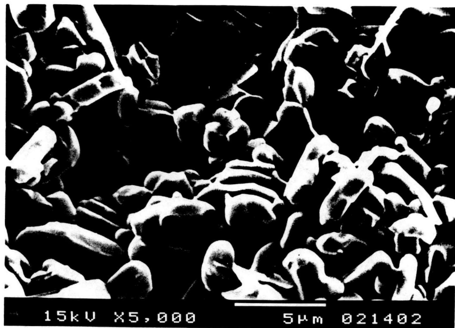
รูปที่ 5.16 แสดงภาพถ่ายจุลโครงสร้างจากกล้องจุลทรรศน์อิเล็กตรอนแบบส่องกราดของแท่งกรองอะลูมินา ที่อุณหภูมิ 1300 องศาเซลเซียส ปริมาณน้ำ 14.5 เปอร์เซ็นต์ และขนาดอะลูมินา 18.91 ไมโครเมตร
