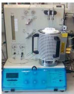
รูปที่ 3.8 เครื่องยี่ห้อ Quantachrome® รุ่น ChemBET Pulsar TPR/TPD
