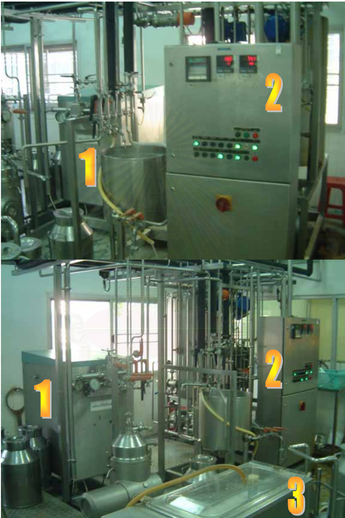
รูปที่ ง.4 1. เครื่อง homogenize 2. เครื่อง pasteurize 3.เครื่องผสมและอุ่นนม
