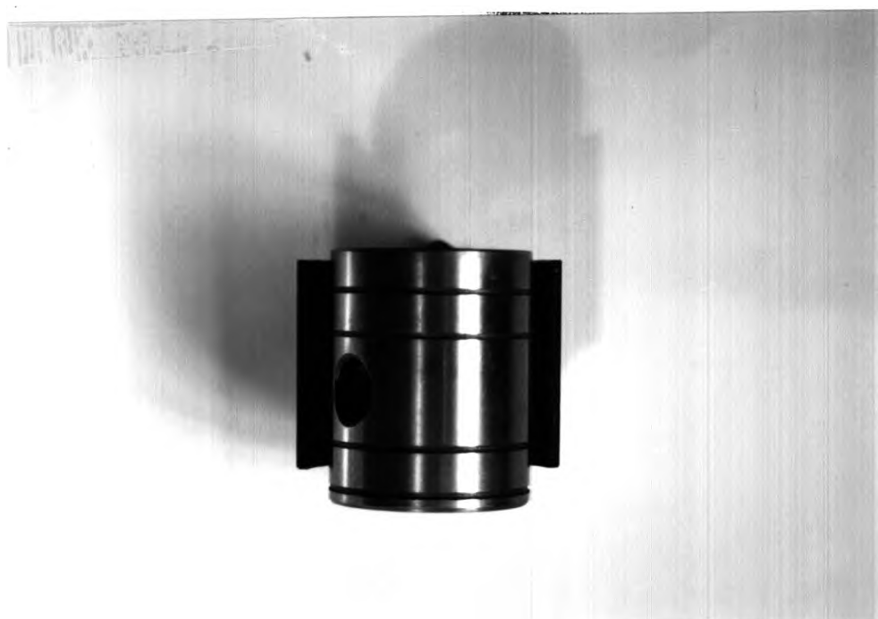
รูปที่ 4.22 แสดงลูกสูบที่ใช้งานกับระบบของ CFC-12
