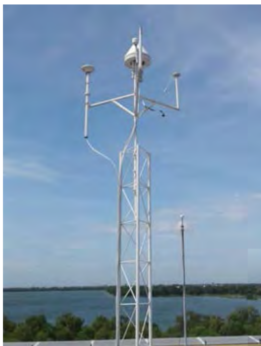
รูปที่ 1.3 เสารับสัญญาณ GNSS ยี่ห้อ Javad L1/L2
