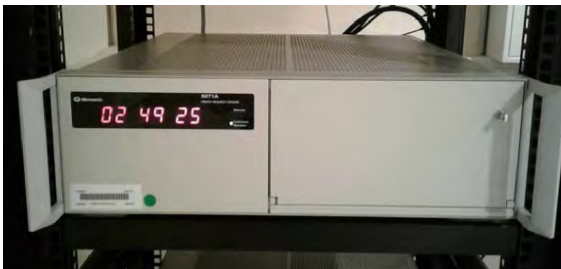
รูปที่ 1.8 นาฬิกาอะตอมซีเซียม (Cesium Atomic Clock) รุ่น 5071A-001
