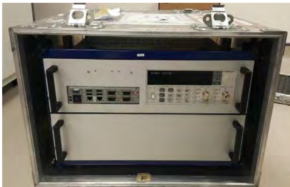
รูปที่ 1.7 เครื่องนับเวลา (Universal Counter) รุ่น 53132A
