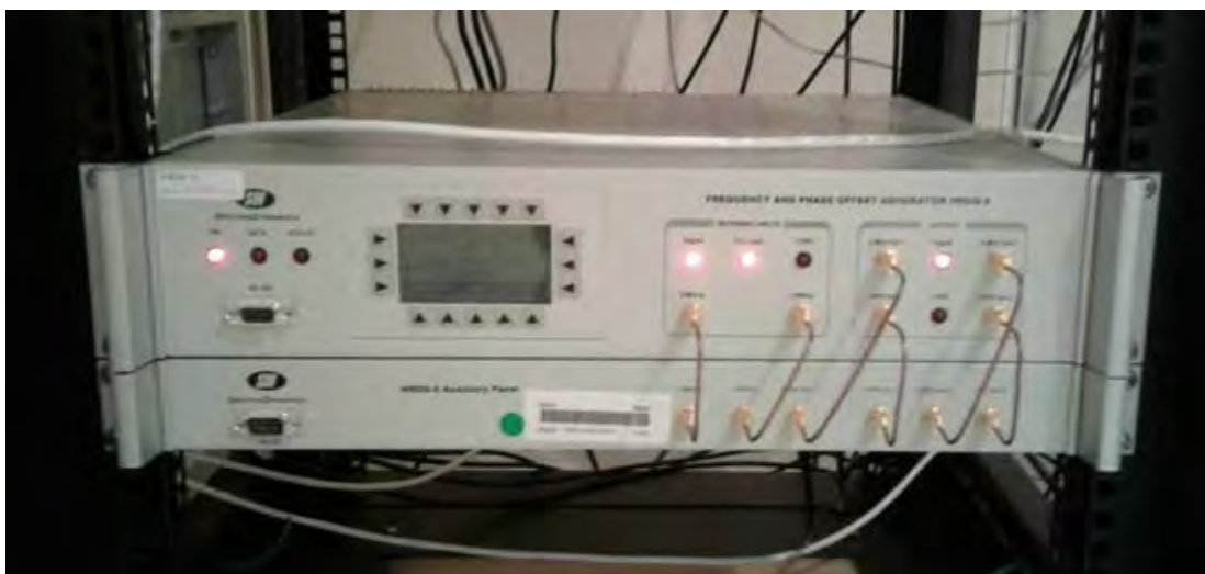
รูปที่ 1.10 เครื่องปรับแก้เวลาและความถี่ (Micro Stepper) ยี่ห้อ SDI รุ่น HROG-10RM
