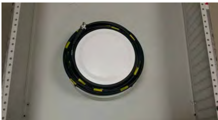
รูปที่ 1.4 สายโคแอกเซียล (Coaxial Cable) ชนิด Outdoor ยี่ห้อ LMR รุ่น LMR-400
