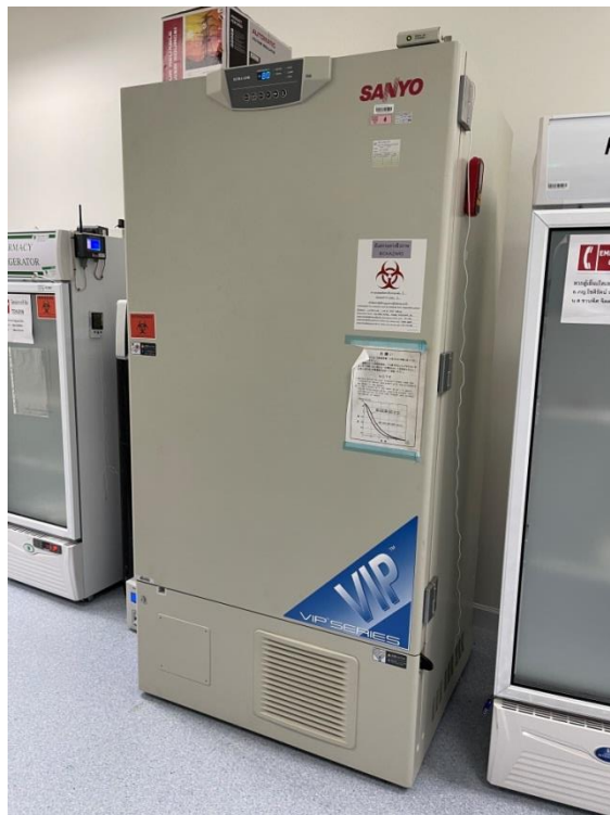
รูปภาพ 2 แสดงตู้แช่แข็งที่อุณหภูมิ -80 องศาเซลเซียส
