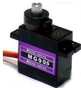
รูปที่ 3. 26 ลักษณะของเซอร์โวมอเตอร์ MG 90 s (Tower pro)
