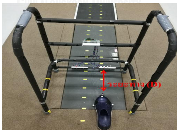
รูปที่ 3. 13 การทดสอบความถูกต้องในช่วง static ( กล้องคู่ขวาและรองเท้าข้างขวา )
