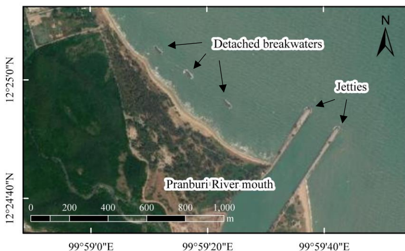
รูป 4.3 เขื่อนกันทรายและคลื่นและเขื่อนกันคลื่นที่บริเวณปากน้ำปราณบุรี
