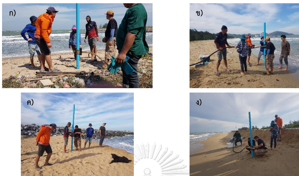
รูป 3.4 การเก็บตัวอย่างแท่งตะกอน (sediment core) บริเวณปากน้ำปราณบุรี ก) core 1, ข) core 2, ค) core 3, และ ง) core 4
