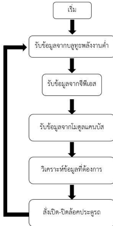
รูปที่ 19 แผนผังการทำงานส่วนรับข้อมูลจากรถยนต์
