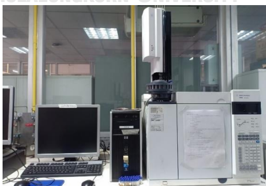
ภาพที่ 3. 5 เครื่องแก๊สโครมาโทกราฟีจำลองการกลั่น
