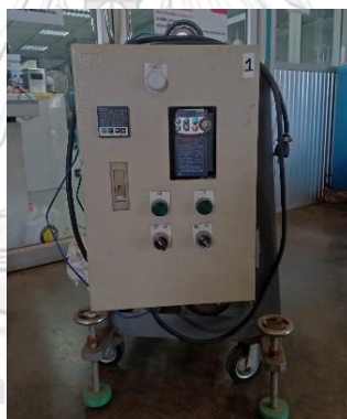
ภาพที่ 3. 3 อุปกรณ์ควบคุมอุณหภูมิแบบดิจิทัล หม้อแปลงไฟฟ้าและเครื่องเขย่า
