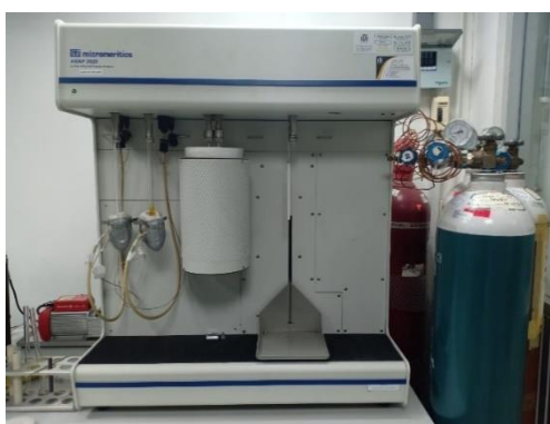
ภาพที่ 3. 8 เครื่องวัดพื้นที่ผิวและความเป็นรูพรุนด้วยเทคนิคการวัดการดูดซับไนโตรเจน
