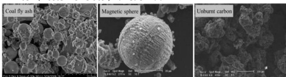
ภาพที่ 2.10 ภาพถ่านลอมถ่านหินจากกล้องจุลทรรศน์แบบส่องกราด [30]
