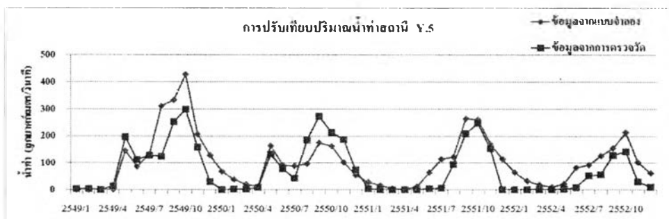
รูปที่ 4-17 ผลการเปรียบเทียบปริมาณน้ำท่าจากการคำนวณแบบจำลอง SWAT เทียบกับค่าจากการตรวจวัดที่สถานี Y.5
