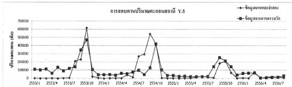
รูปที่ 4-28 ผลการสอบทานปริมาณตะกอนจากการคำนวณแบบจำลอง SWAT เทียบกับค่าจากการตรวจวัดที่สถานี Y.5
