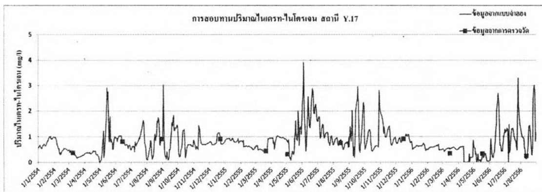
รูปที่ 4-39 ผลการสอบทานปริมาณไนเตรท-ไนโตรเจนจากการคำนวณแบบจำลอง SWAT เทียบกับค่าจากการตรวจวัดที่สถานี Y.17
