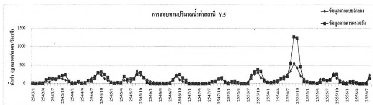
รูปที่ 4-18 ผลการสอบทานปริมาณน้ำท่าจากการคำนวณแบบจำลอง SWAT เทียบกับค่าจากการตรวจวัดที่สถานี Y.5
