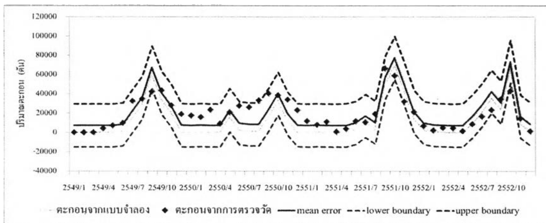
รูปที่ 4-85 ผลการวิเคราะห์ความไม่แน่นอนจากแบบจำลองของตะกอนในการเปรียบเทียบ สถานี Y.17
