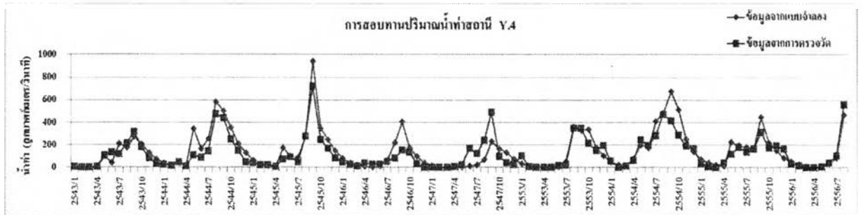
รูปที่ 4-12 ผลการสอบทานปริมาณน้ำท่าจากการคำนวณแบบจำลอง SWAT เทียบกับค่าจากการตรวจวัดที่สถานี Y.4
