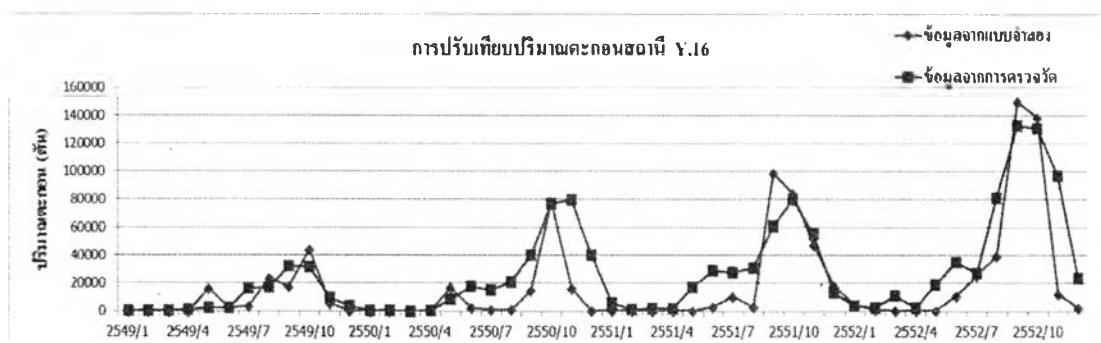
รูปที่ 4-23 ผลการปรับเทียบปริมาณตะกอนจากการคำนวณแบบจำลอง SWAT เทียบกับค่าจากการตรวจวัดที่สถานี Y.16
