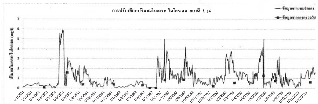
รูปที่ 4-35 ผลการเปรียบเทียบปริมาณไนเตรท-ไนโตรเจน จากการคำนวณแบบจำลอง SWAT เทียบกับค่าจากการตรวจวัดที่สถานี Y.16
