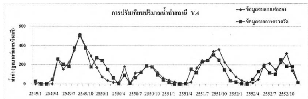
รูปที่ 4-11 ผลการปรับเทียบปริมาณน้ำท่าจากการคำนวณแบบจำลอง SWAT เทียบกับค่าจากการตรวจวัดที่สถานี Y.4
