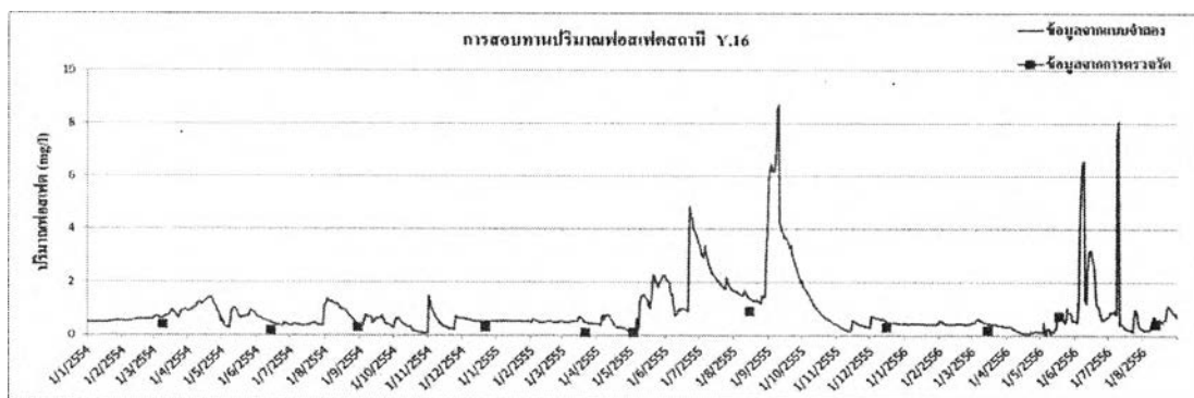
รูปที่ 4-51 ผลการสอบทานปริมาณฟอสเฟต จากการคำนวณแบบจำลอง SWAT เทียบกับค่าจากการตรวจวัดที่สถานี Y.16
