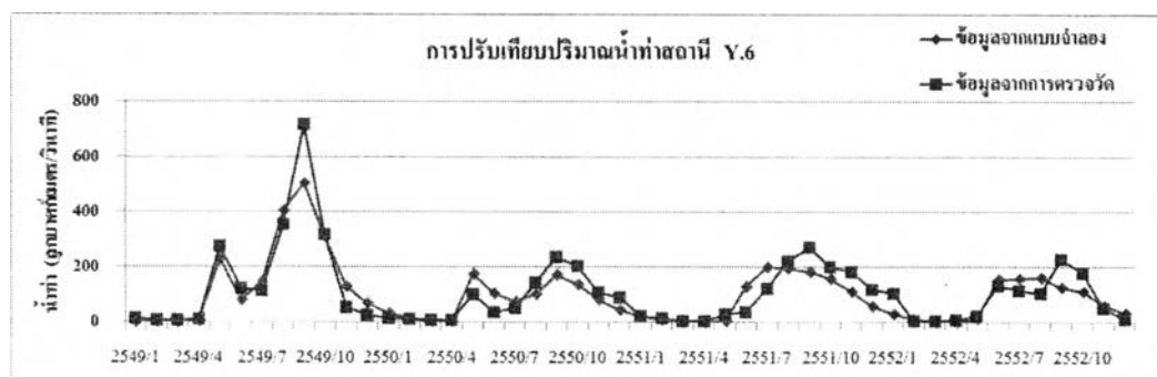
รูปที่ 4-9 ผลการปรับเทียบปริมาณน้ำท่าจากการคำนวณแบบจำลอง SWAT เทียบกับค่าจากการตรวจวัดที่สถานี Y.6
