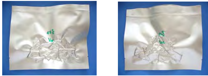
รูปที่ ข.18 เหมเป็ผสมข้าวโพดทอดกรอบบรรจุในถุงอะลูมิเนียมฟลอยด์ (Foil pouch) ขนาด 20 x 16 เซนติเมตร หนา100µm OPP/PE/Alu/PE/LL ปิดผนึกแบบสุญญากาศ แล้วเก็บในสภาวะเร่งที่อุณหภูมิ 45°C (ซ้าย) และ 55°C (ขวา)
