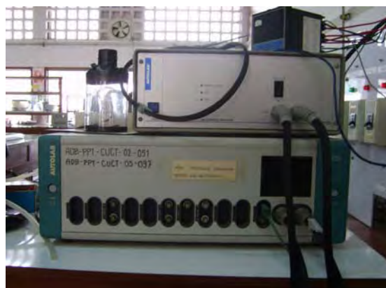
รูปที่ 3.2 ระบบทดสอบสมรรถนะของเซลล์เชื้อเพลิงสำหรับเซลล์เดี่ยวที่ใช้ในการทดลอง
