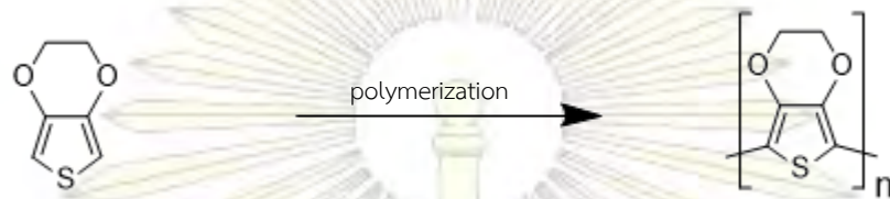
แผนภาพที่ 2-6 การสังเคราะห์พอลิ(3,4-เอทิลีนไดออกซีไทโอฟีน)
