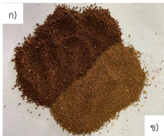
รูปที่ 4.1 ก) เมล็ดกาแฟคั่วบดก่อนการสกัด และ ข) เมล็ดกาแฟคั่วบดหลังการสกัด
