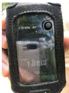
ภาพที่ 3-3 เครื่องหาพิกัดด้วยสัญญาณดาวเทียม
