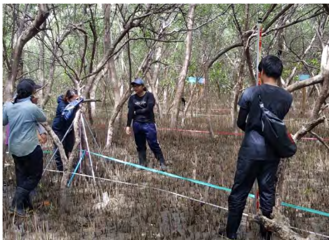
ภาพที่ 3-8 การวัดระดับความสูงของพื้นที่แต่ละแนวศึกษาโดยใช้ Instrumental sideline builders level และไม้วัดระดับ
