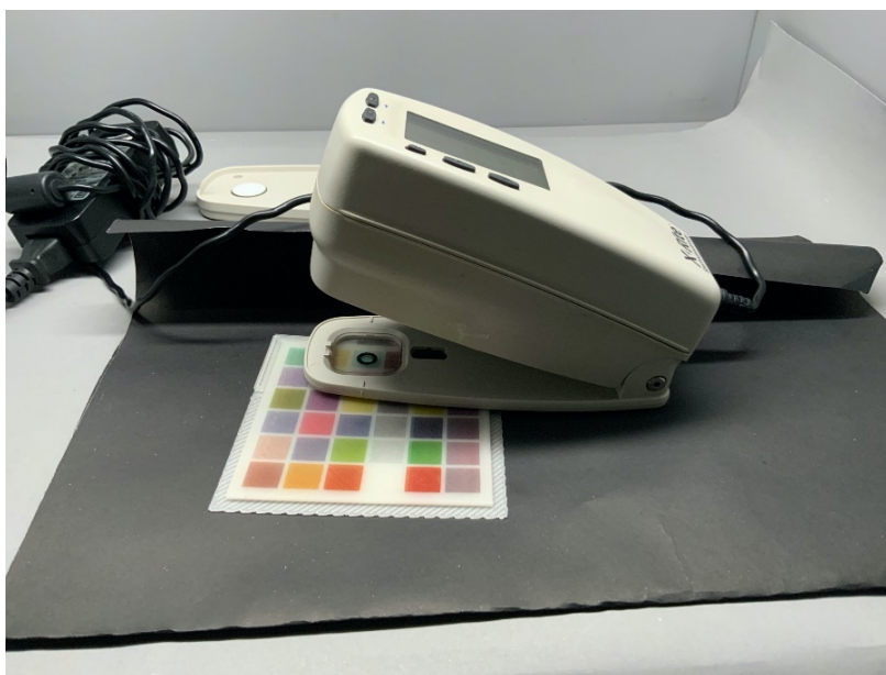
รูปที่ 3.7 การวัดค่าสี L^*a^*b^* ด้วยเครื่องวัดสี Spectrodensitometer ยี่ห้อ X-Rite รุ่น 500 series
