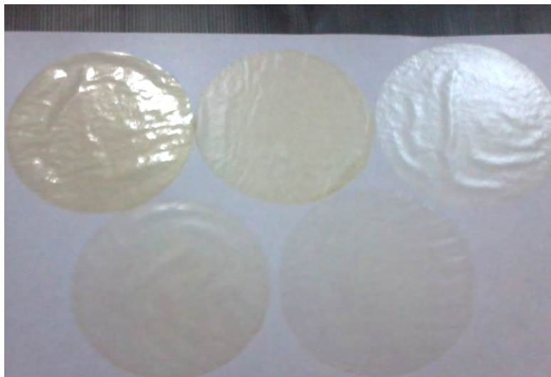
รูปที่ ข.2.11 फिल्मที่ผลิตจากโปรตีนถั่วเหลืองสกัดและเจลาตินที่เติมทรานส์กลูตามิเนสเข้มข้น 8 หน่วย/g โปรตีนและกลีเซอรอลเข้มข้น 60% โดยน้ำหนักของโปรตีน แฉบบนจากข้าวไปขวา คือ फिल्मที่ใช้อัตราส่วนของโปรตีนถั่วเหลืองสกัดต่อเจลาตินเท่ากับ 100:0, 75:25 และ 50:50 แฉบล่างจากข้าวไปขวา คือ फिल्मที่ใช้อัตราส่วนของโปรตีนถั่วเหลืองสกัดต่อเจลาตินเท่ากับ 25:75 และ 0:100
