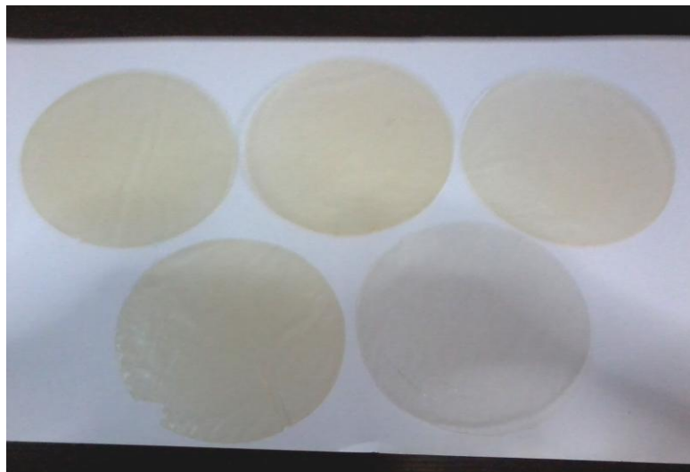
รูปที่ ข.2.9 फिल्मที่ผลิตจากโพรตีนถั่วเหลืองสกัดและเจลาตินที่เติมทรานส์กลูตามิเนสเข้มข้น 4 หน่วย/g โพรตีนและกลีเซอรอลเข้มข้น 65% โดยน้ำหนักของโพรตีน แฉวนบนจากข้าวไปขาวาคือ फिल्मที่ใช้อัตราส่วนของโพรตีนถั่วเหลืองสกัดต่อเจลาตินเท่ากับ 100:0, 75:25 และ 50:50 แฉวนล่างจากข้าวไปขาวาคือ फिल्मที่ใช้อัตราส่วนของโพรตีนถั่วเหลืองสกัดต่อเจลาตินเท่ากับ 25:75 และ 0:100
