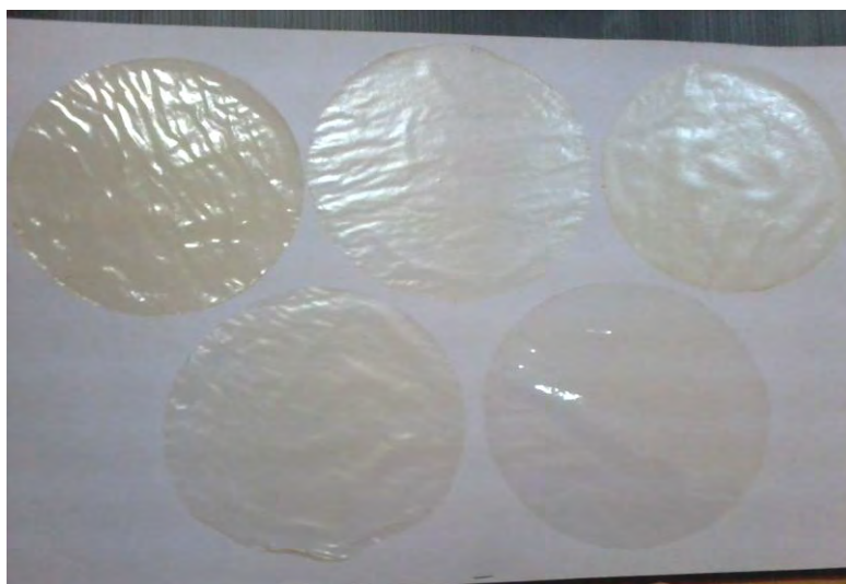
รูปที่ ข.2.6 फिल्मที่ผลิตจากโปรตีนถั่วเหลืองสกัดและเจลาตินที่ไม่เติมทรานส์กลูตามีน และเติมกลีเซอรอลเข้มข้น 65% โดยน้ำหนักของโปรตีน แลวนจากข้าวไปขวา คือ फिल्मที่ใช้อัตราส่วนของโปรตีนถั่วเหลืองสกัดต่อเจลาตินเท่ากับ 100:0, 75:25 และ 50:50 แลวงจากข้าวไปขวา คือ फिल्मที่ใช้อัตราส่วนของโปรตีนถั่วเหลืองสกัดต่อเจลาตินเท่ากับ 25:75 และ 0:100
