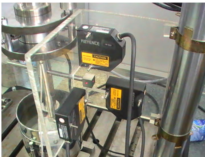
รูปที่ 5.14 การติดตั้งอุปกรณ์วัดค่าการเสียรูปและก้านสำหรับวัดให้อยู่ในตำแหน่งใช้งาน
