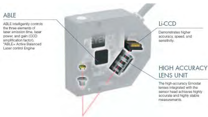
รูปที่ 4.16 เซ็นเซอร์วัดตำแหน่งแบบเลเซอร์
