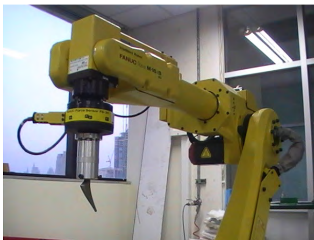
รูปที่ 5.5 การติดตั้งอุปกรณ์จัดวางกับหุ่นยนต์
