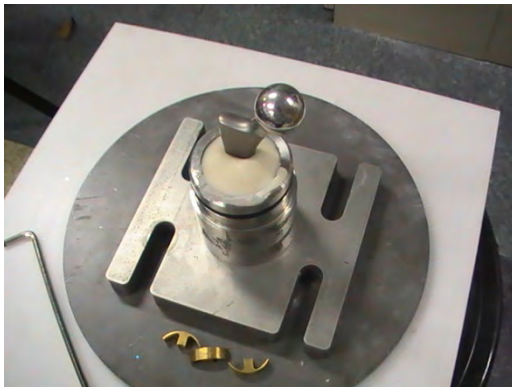
รูปที่ 5.10 ก้านสะโพกที่ฝังอยู่ในฐานฝังเรียบร้อยแล้ว
