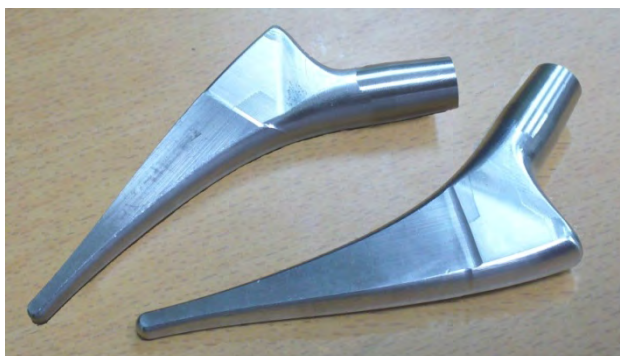
รูปที่ 4.9 ชิ้นงานก้านสะโพกซึ่งกัดเสร็จแล้ว
