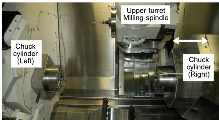
รูปที่ 4.2 หัวจับทั้งสองฝั่งของเครื่องกัดชิ้นงานแบบซีเอ็นซี
