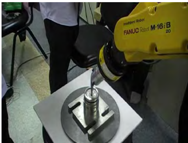
รูปที่ 5.9 หมุนก้านสะโพกให้อยู่ในมุมตามมาตรฐานและจุ่มก้านสะโพกลงในฐานฝัง
