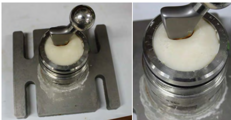
รูปที่ 5.28 สภาพของก้านสะโพกและซีเมนต์กระดูกหลังการทดสอบความทนทานต่อความล้า
