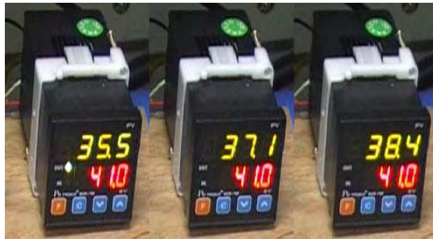
รูปที่ 5.19 ผลการควบคุมอุณหภูมิของก้อนสะโพก
