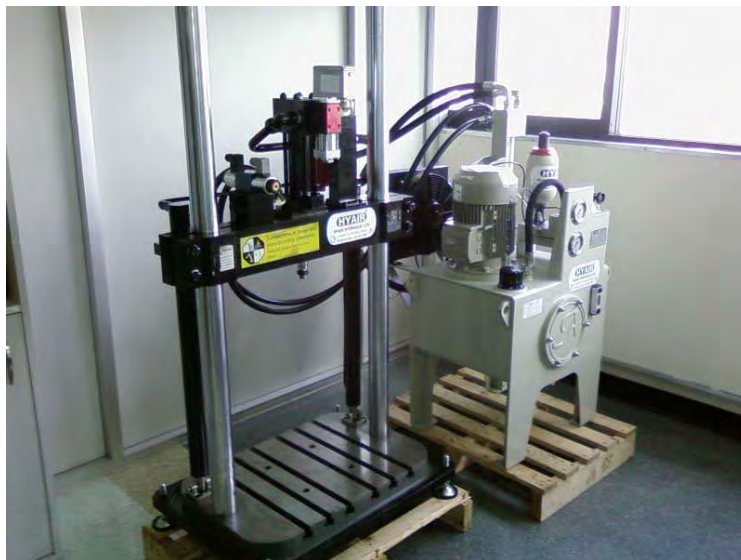
รูปที่ 4.12 เครื่องทดสอบความล้าหลังติดตั้งระบบไฮดรอลิก
