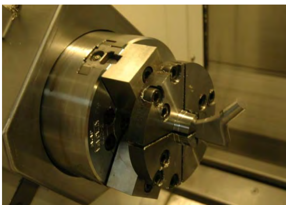
รูปที่ 4.8 ชิ้นงานก้านสะโพกซึ่งกัดเสร็จแล้วบนหัวจับฝั่งซ้าย
