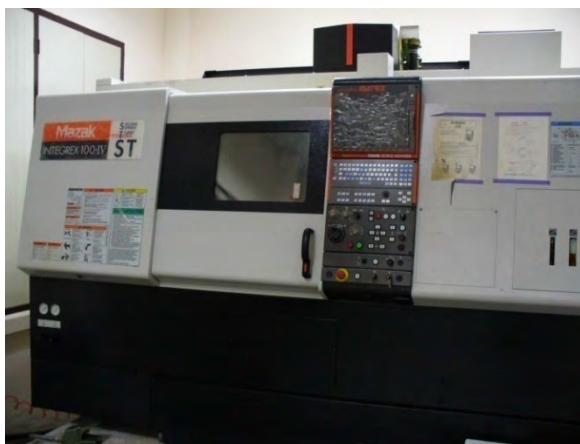
รูปที่ 4.1 เครื่องกัดชิ้นงานแบบซีเอ็นซี Mazak Integrex 100-IV ST
