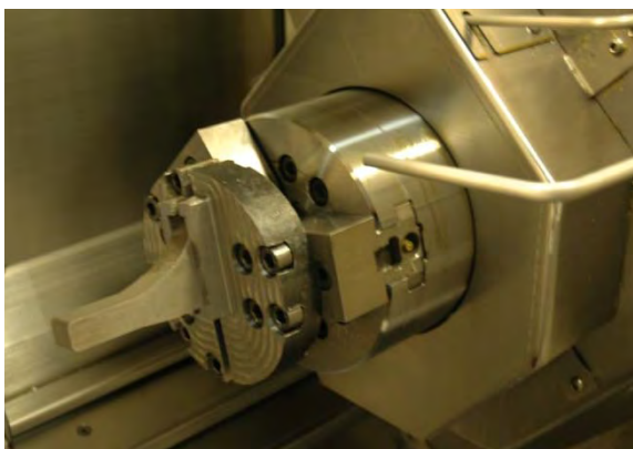
รูปที่ 4.7 ชิ้นงานวัตถุดิบสำหรับกัดก้านสะโพกบนหัวจับฝั่งขวา
