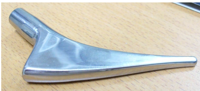
รูปที่ 4.10 ก้านสะโพกหลังจากขัดด้วยกระดาษทราย
