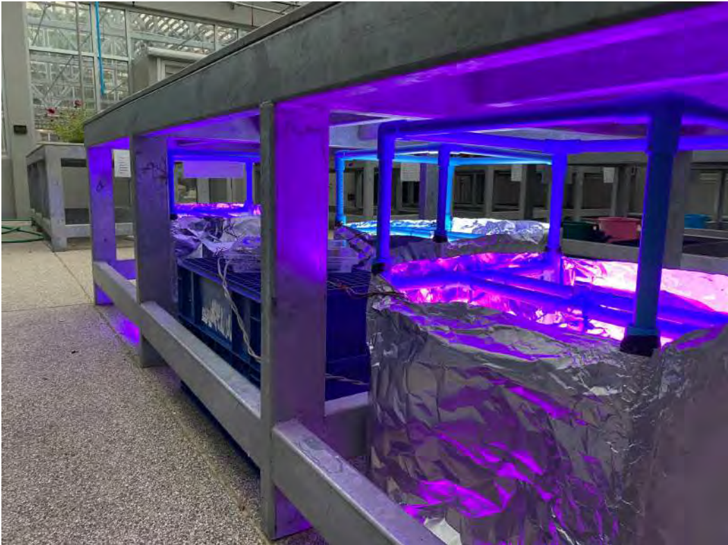
ภาพที่ 12 โครงแอลอีดีติดตั้งใต้โต๊ะภายในโรงเรือน
