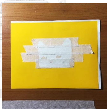
Figure 69 ใช้เทปกาวติดผิวหน้าสติ๊กเกอร์ เพื่อไม่ให้ตำแหน่งของสติ๊กเกอร์เคลื่อน
