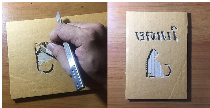
Figure 48 ตัดแยกส่วนที่ไม่ต้องการแล้วดึงออกจากแม่พิมพ์
