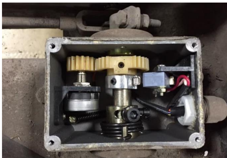
ภาพที่ 40 ชุดปรับค่าแรงดันทางไฟฟ้าบริเวณใต้คันเร่ง
