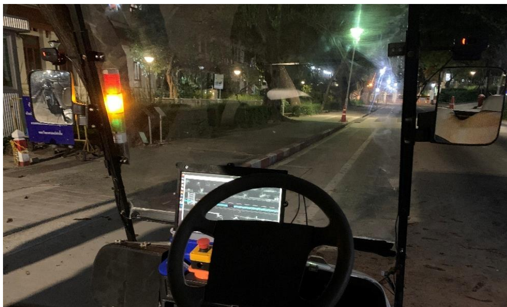
ภาพที่ 94 ระบบเข้าสู่โหมดควบคุมด้วยระบบอัตโนมัติ ณ จุดที่ 1 (รถทดสอบ)
