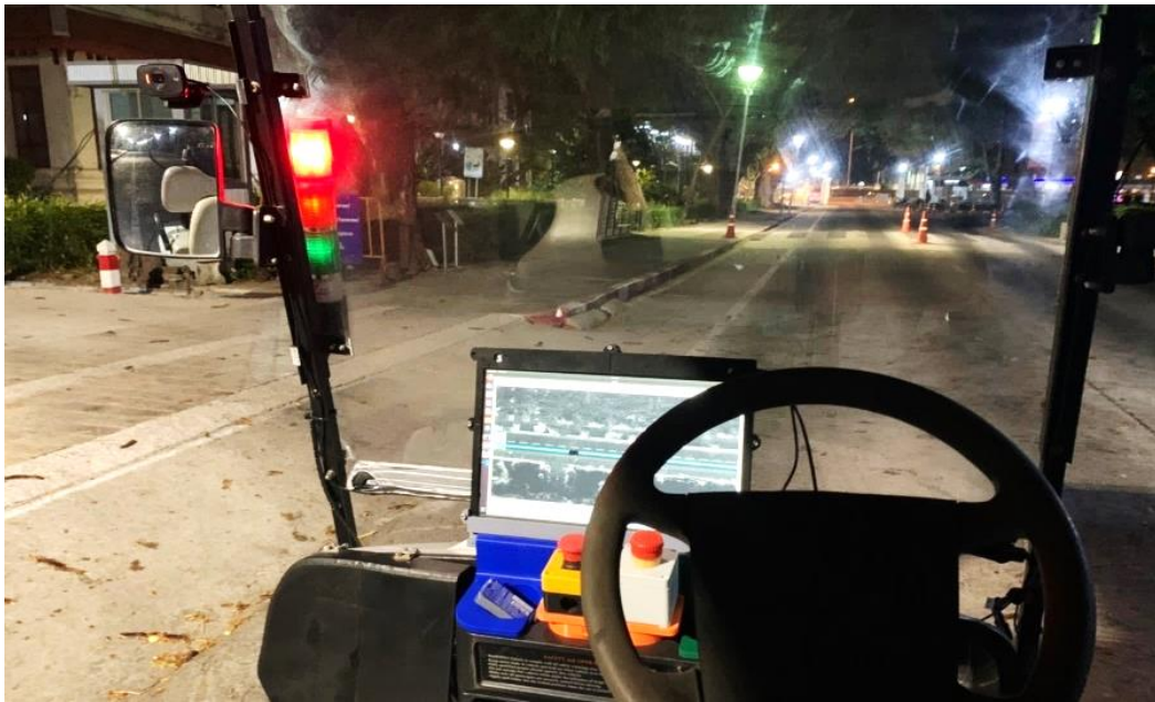
ภาพที่ 92 ระบบเข้าสู่โหมดฉุกเฉินขณะทำการควบคุมจากรยะไกล ณ จุดที่ 1 (รถทดสอบ)
