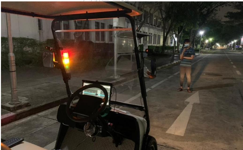
ภาพที่ 104 ระบบเข้าสู่โหมดฉุกเฉินขณะพบสิ่งกีดขวางระหว่างการควบคุมด้วยระบบอัตโนมัติ ณ จุดที่ 4 (รถทดสอบ)
