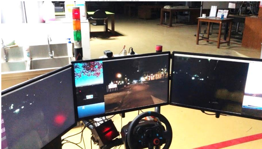
ภาพที่ 101 ระบบเข้าสู่โหมดฉุกเฉินขณะทำการควบคุมจากระยะไกล ณ จุดที่ 3 (สถานีควบคุม)
