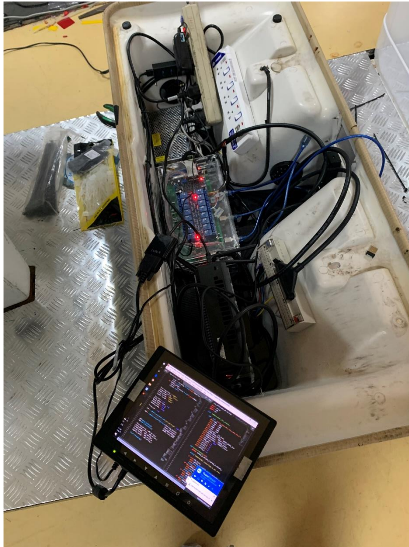
ภาพที่ 51 ชุดควบคุมของทั้งระบบบังคับลิ้นว ระบบควบคุมอัตราเร็ว และระบบเบรกถูกติดตั้งภายใต้ เบาะแถวที่สอง ของรถกอล์ฟไฟฟ้า
