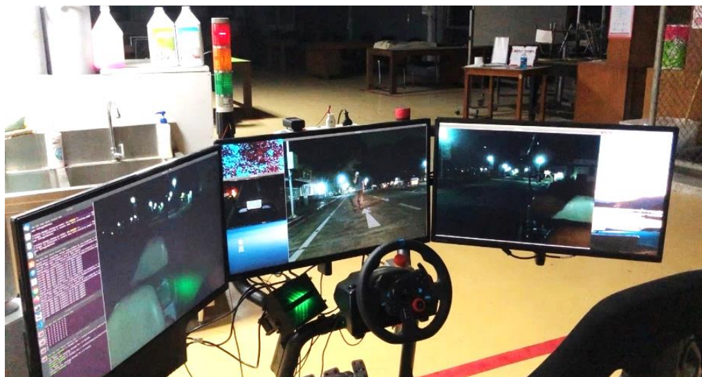
ภาพที่ 105 ระบบเข้าสู่โหมดฉุกเฉินขณะพบสิ่งกีดขวางระหว่างการควบคุมด้วยระบบอัตโนมัติ ณ จุดที่ 4 (สถานีควบคุม)
