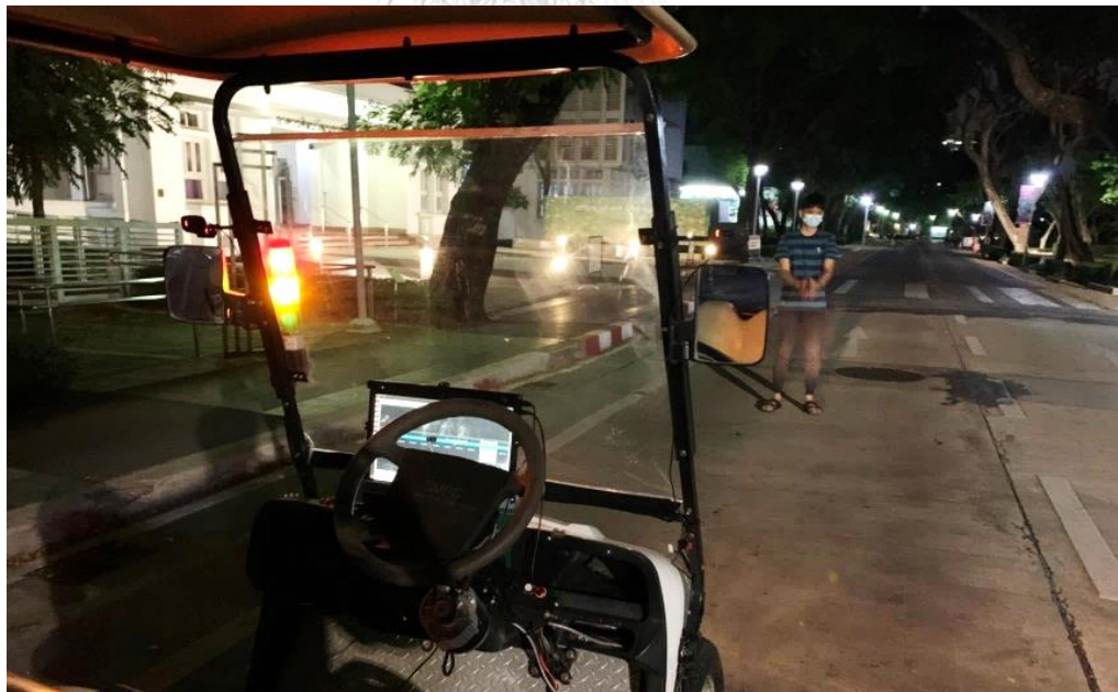
ภาพที่ 96 ระบบเข้าสู่โหมดฉุกเฉินขณะพบสิ่งกีดขวางระหว่างการควบคุมด้วยระบบอัตโนมัติ ณ จุดที่ 2 (รถทดสอบ)
