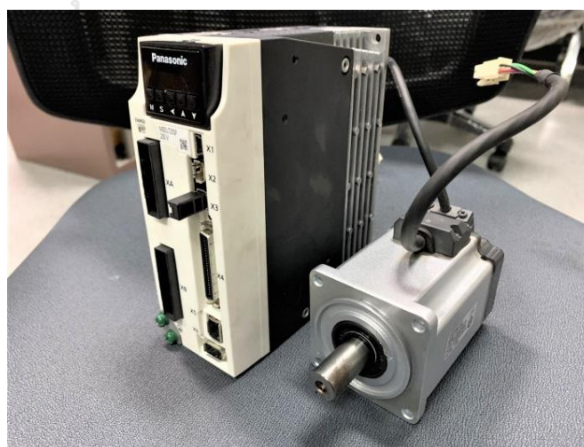
ภาพที่ 46 เซอร์โวมอเตอร์ที่ใช้ในระบบเบรกล้างงานด้วยสัญญาณทางไฟฟ้า
