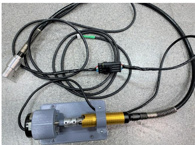
ภาพที่ 37 เซ็นเซอร์วัดอัตราเร็วจากการหมุนของล้อแบบใช้สายอ่อน
