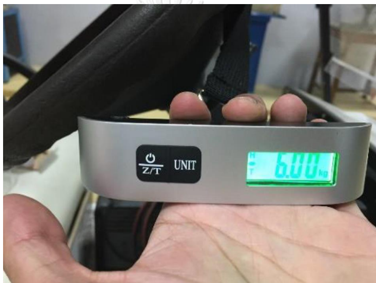
ภาพที่ 22 ค่าที่วัดได้จากการทดลองการหมุนพวงมาลัยโดยใช้เครื่องชั่งวัดแรง
