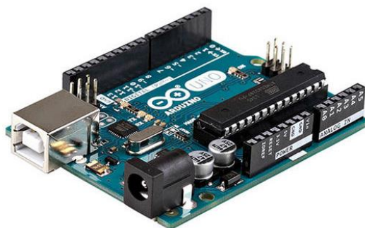
ภาพที่ 28 บอร์ดไมโครคอนโทรลเลอร์ Arduino UNO R3
