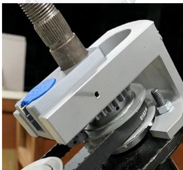
ภาพที่ 26 ลักษณะการติดตั้งอุปกรณ์วัดตำแหน่งการหมุนของพวงมาลัย
