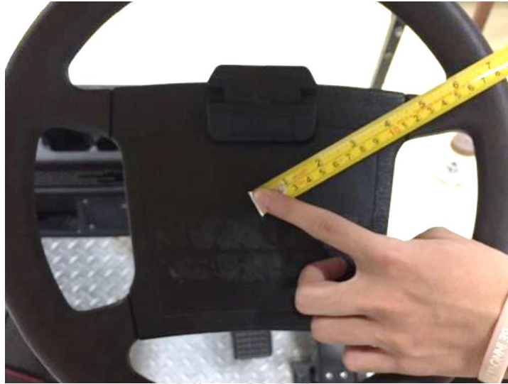
ภาพที่ 23 ระยะตั้งฉากจากแนวแรงถึงจุดหมุน
