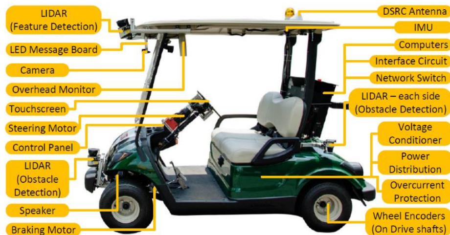
ภาพที่ 3 รถกอล์ฟไฟฟ้าที่ถูกดัดแปลงและเพิ่มเติมชุดอุปกรณ์ควบคุมให้เป็นรถอัตโนมัติในงานวิจัย[8]
