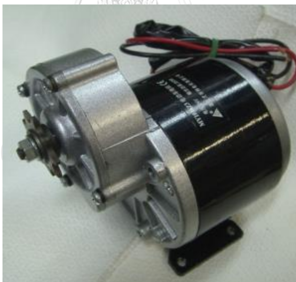
ภาพที่ 24 มอเตอร์กระแสตรงในระบบบังคับเลี้ยวทำงานด้วยสัญญาณทางไฟฟ้า
