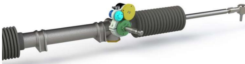
ภาพที่ 1 ลักษณะระบบบังคับเลี้ยวสั่งงานด้วยสัญญาณทางไฟฟ้า[5, 6]
