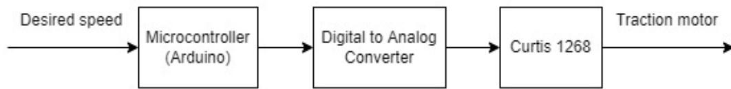
ภาพที่ 41 การสั่งอัตราเร็วยานยนต์ต้นแบบโดยใช้วงจรแปลงสัญญาณดิจิทัลเป็นอนาล็อก เพื่อปรับแรงดันไฟฟ้าของ Throttle pot
