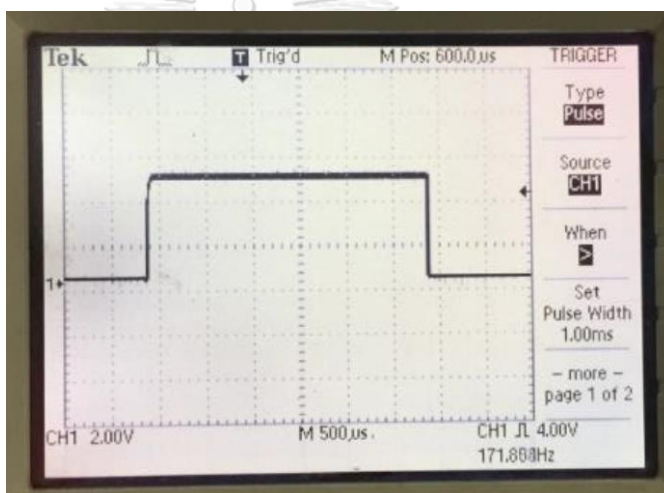
ภาพที่ 36 ความถี่สูงสุดที่วัดได้จาก Speed sensor ขณะเร่งอัตราเร็วสูงสุด
