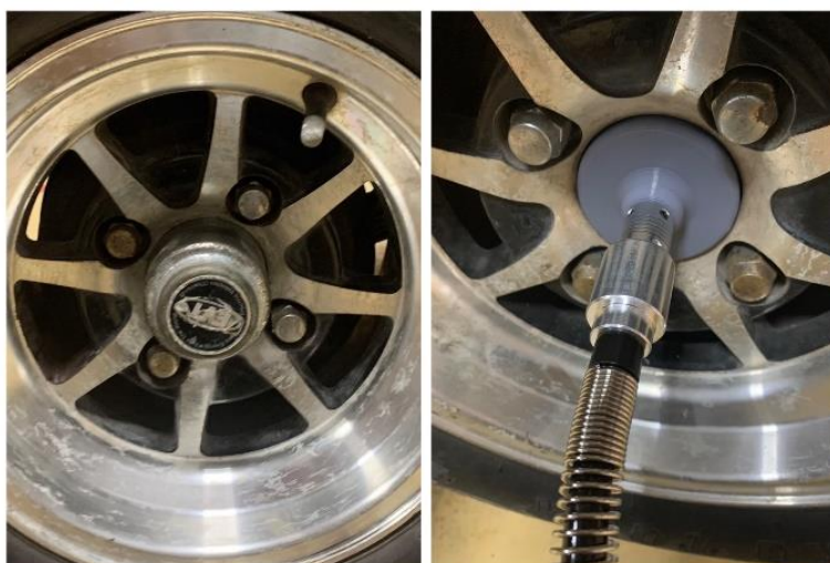
ภาพที่ 38 ฝาครอบล้อรถที่ออกแบบใหม่โดยเฉพาะ(รูปขวา) สำหรับจับกับแกนสายอ่อน
