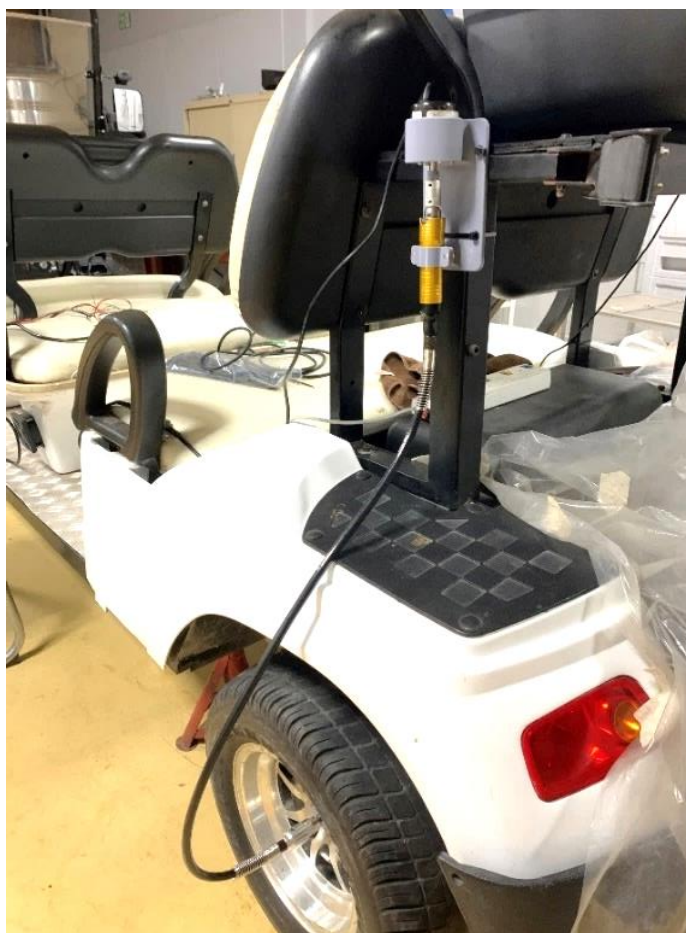
ภาพที่ 39 ลักษณะการติดตั้งเซ็นเซอร์วัดอัตราเร็วของรถจากการวัดอัตราการหมุนของล้อ
