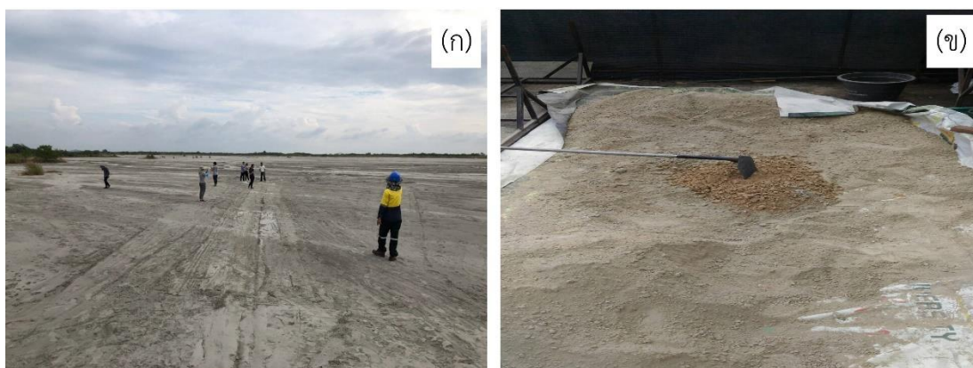
รูปที่ 3.1 การเตรียมภาคโลหกรรม; (ก) บ่อกักเก็บภาคโลหกรรมของเหมืองแร่ทองคำที่ตั้งอยู่ในพื้นที่ศักยภาพแหล่งแร่ทองคำบริเวณจังหวัดพิจิตร เพชรบูรณ์ และพิษณุโลก และ (ข) การคลุกผสมตัวอย่างภาคโลหกรรม
