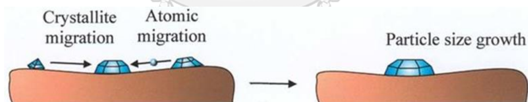
รูปที่ 2.31 การรวมตัวเนื่องจากความร้อนของตัวเร่งปฏิกิริยา [ 64 ]
