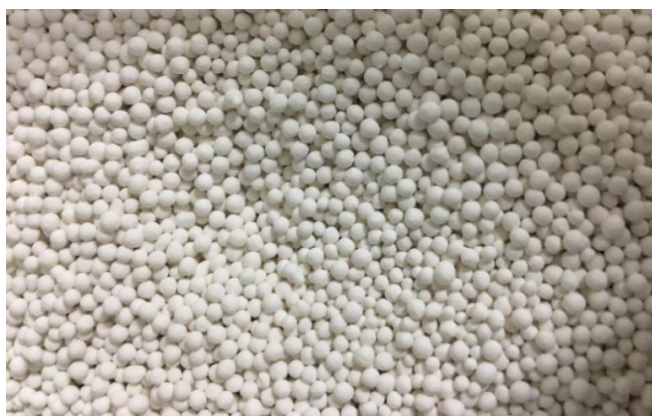
รูปที่ 3.5 ตัวรองรับแกมมาอะลูมินาที่ใช้ในการทดลอง
