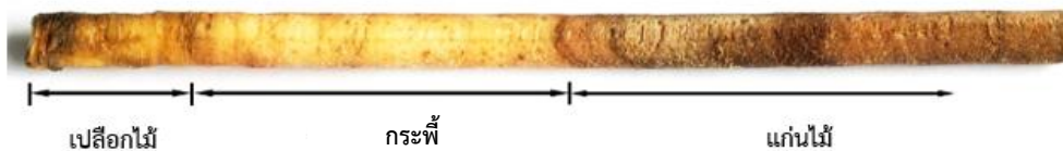
ภาพที่ 2.7 แสดงลักษณะพื้นที่ของตัวอย่างแก่นไม้ โดยแบ่งได้เป็น เปลือกไม้ (Bark) กระพี้ (Sapwood) และแก่นไม้ (Heartwood) ของชนิดพันธุ์ Tectona grandis (G. Yang et al., 2020)
