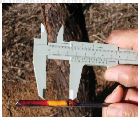
ภาพที่ 2.8 แสดงการวัดขนาดความหนาของกระพี้และลักษณะของตัวอย่างแก่นไม้โดยใช้สีย้อมเมทิลออเรนจ์ 0.1 % (Burgess and Downey, 2014)
